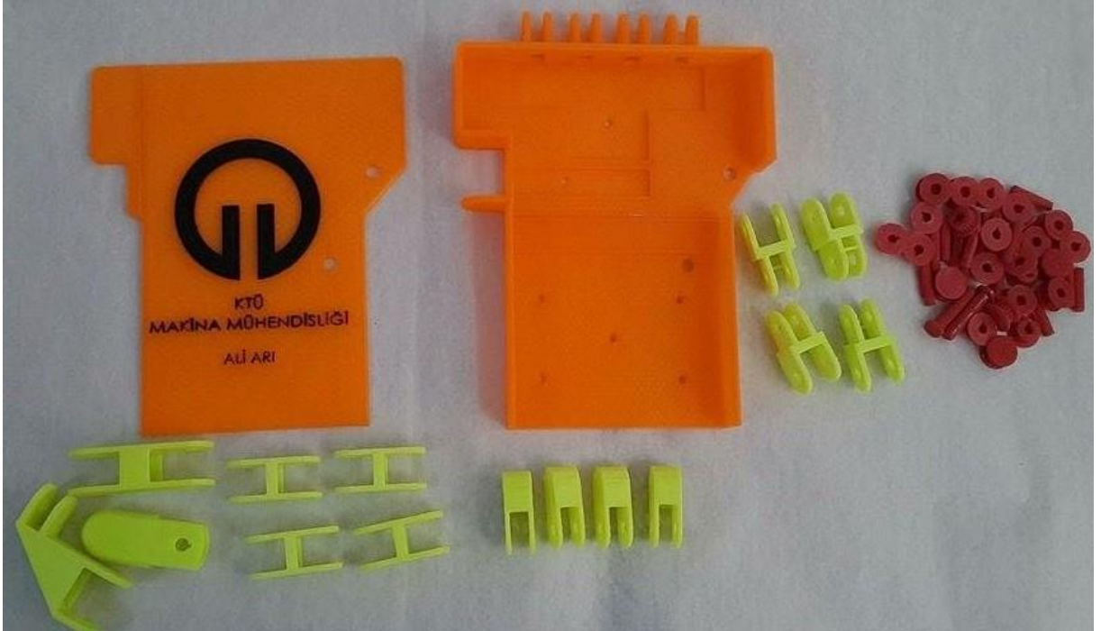
Ek Şekil 4. KTÜ El 3D Yazıcıda İmal Edilen Parçalar
