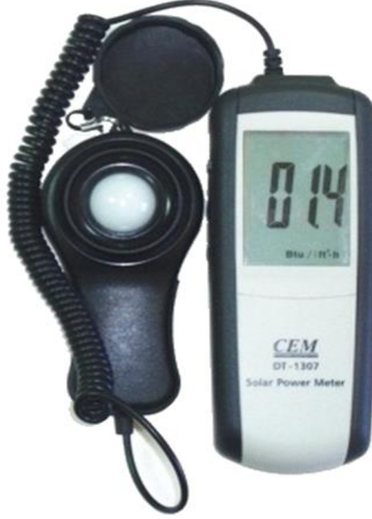
Şekil 34. CEM DT- 1307 Solarimetre
