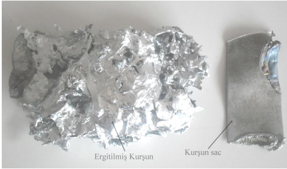
Ek Şekil 7. Kurşun sac ve ergitilen numunenin fotoğrafı
