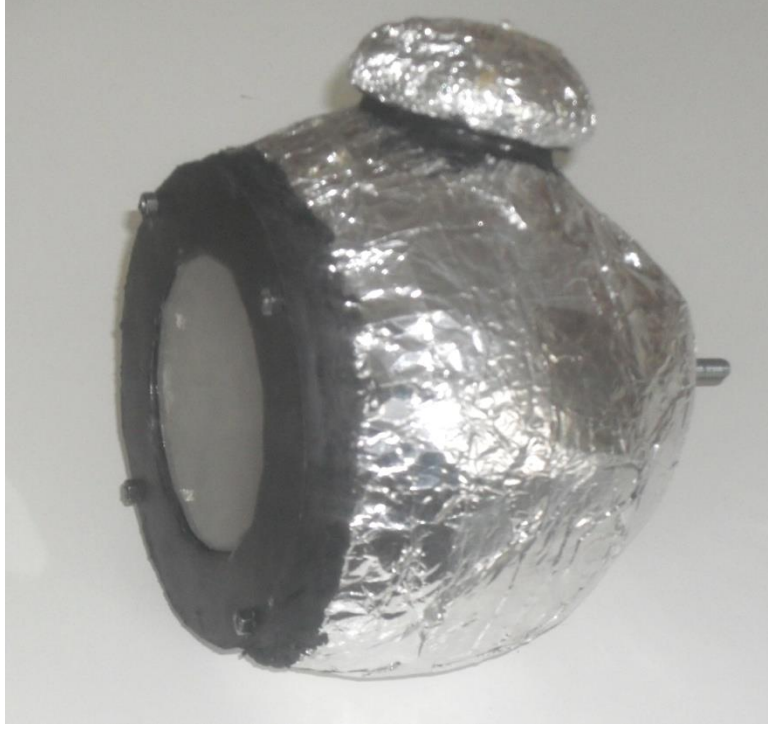
Şekil 25. Tasarlanan potanın cam kaplı fotoğrafı
