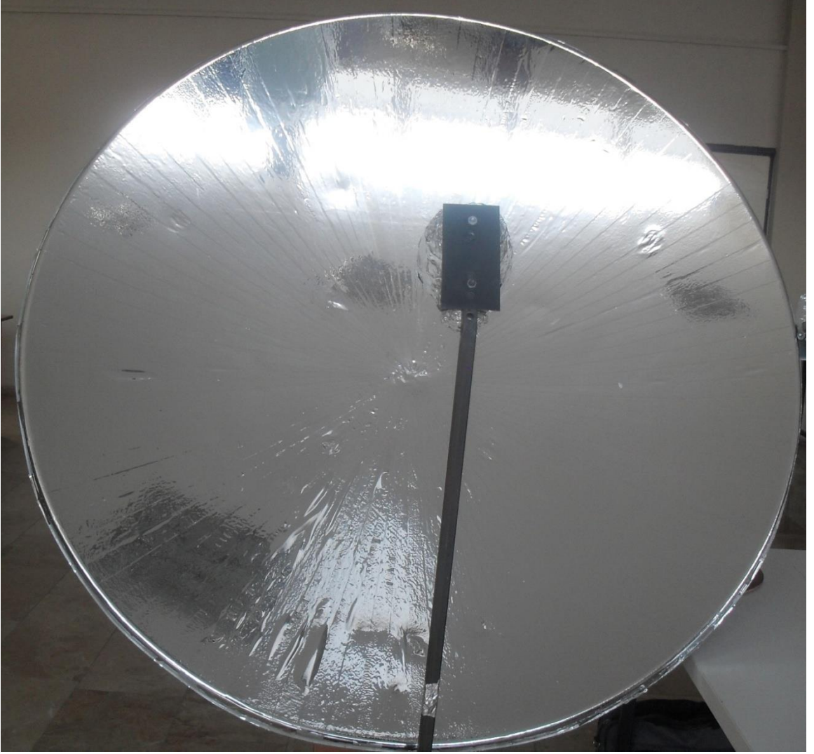
řekil 23. Krom nikelaj ile kaplı parabolik anaęın fotoęrafı
