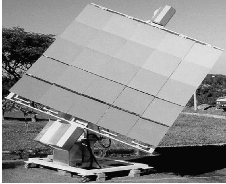
Şekil 17. Heliostatın sütun veya satır hareketinin gösterimi (Chen vd., 2002).
