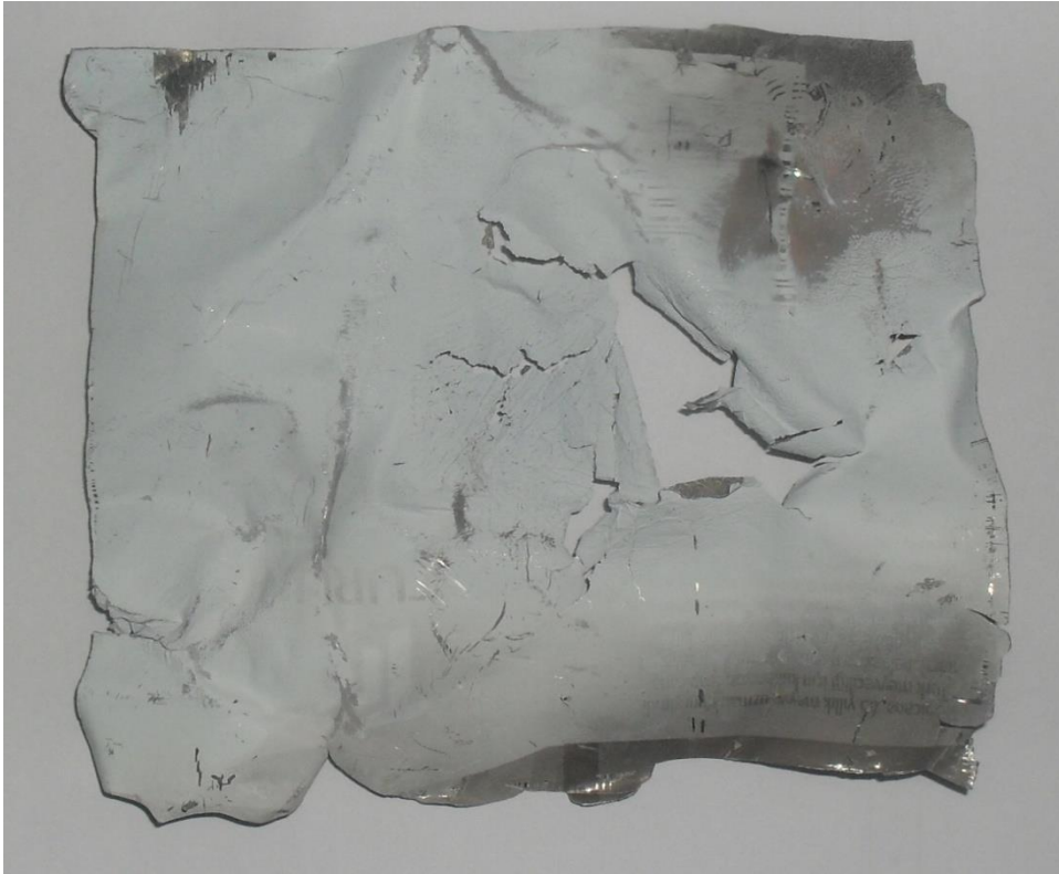
Ek Şekil 6. Ergiyen ince alüminyum sac fotoğrafı
