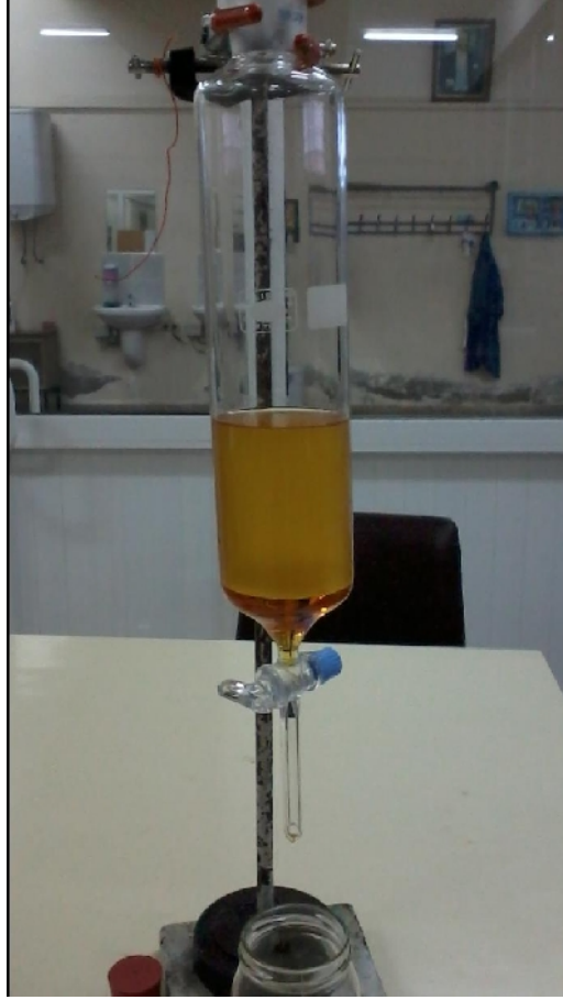
Şekil 2.19. Reaksiyon sonunda meydana gelen karışımın ayırma hunisine alınması ve biyodizel ile gliserin fazının meydana gelmesi
