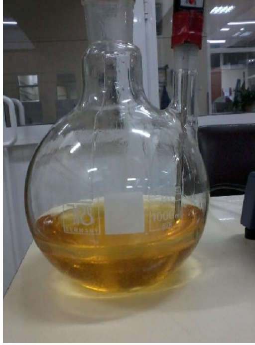
Şekil 2.17. Yağın üstüne metoksit çözeltisinin eklenmesi
