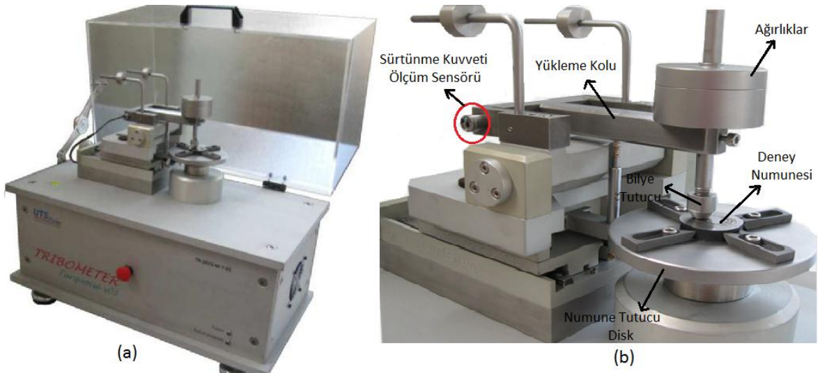
Şekil 12. Aşınma deneylerinin gerçekleştirildiği bilye/pin-on-disk esaslı sürtünme-aşınma deney düzeneğinin (UTS Tribometer T10): (a) genel görünümü ve (b) yükleme sisteminin yakından görünümü
