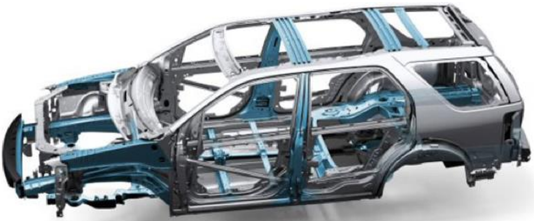
Şekil 1.1. Araç gövdesinde kullanılan ince cidarlı yapılar [6]
