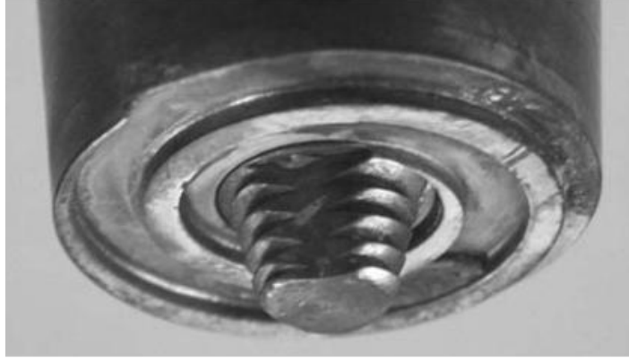
Şekil 10. Kıvrımlı omuz takımının fotoğrafı ve üç kat içeren tepesi kesilmiş koni pim [6].
