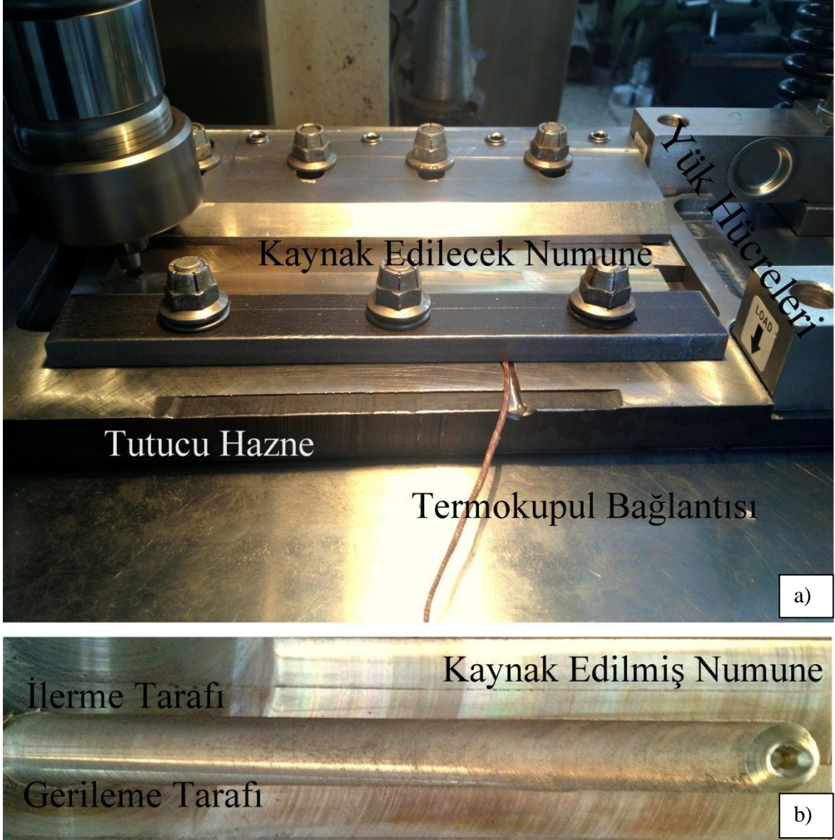
Şekil 54. SKK'nın uygulanış şekli: a) SKK düzeneği ve b) kaynak edilmiş numune
