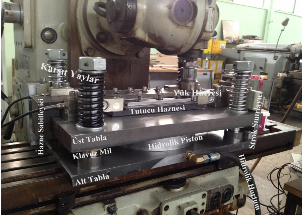
Şekil 49. Hidrolik yüklemeli tablanın görüntüsü
