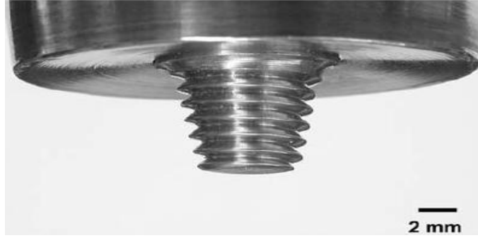
Şekil 14. Tepesi kesilmiş koni pim ve dışbükey omuz sürtünme karıştırma kaynağı takımı [6].
