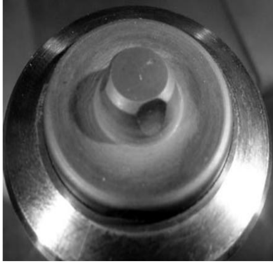
Şekil 19. Vida dışsız pim takımının örneği. Çok kristalli kübik bor nitrid pim takımı ile üç düz pim tipi [6].
