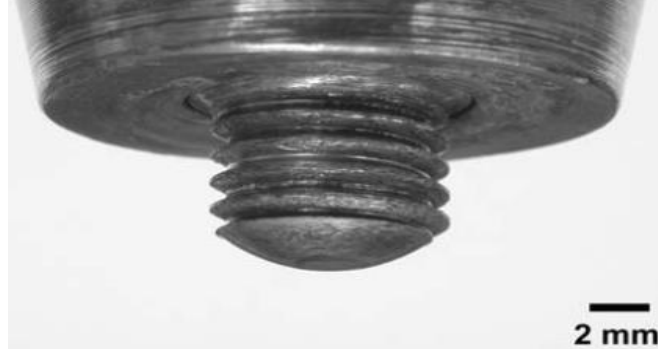
řekil 12. İbkey omuz ile yuvarlak-alt pimin fotoęrafı [6].
