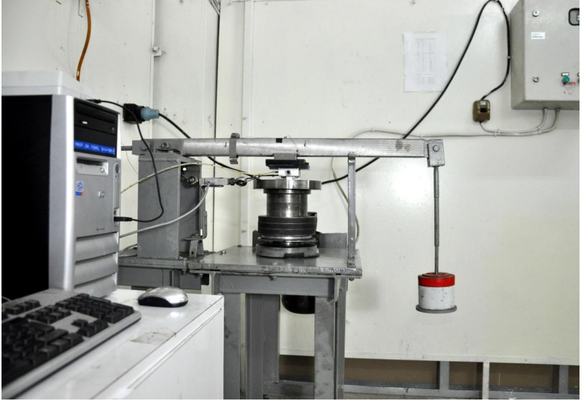
Şekil 8. Aşınma deney düzeneğinin fotoğrafı
