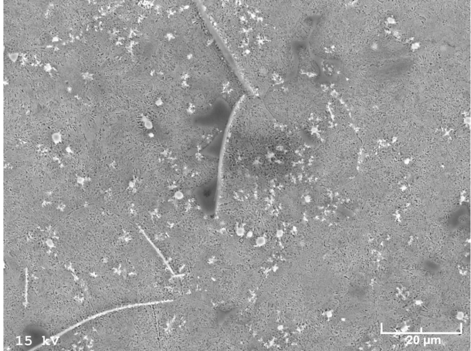
Şekil 16. Zn-25Al-3Cu-1Si alaşımının T7 ısıt işleme görmüş durumdaki içyapısı
