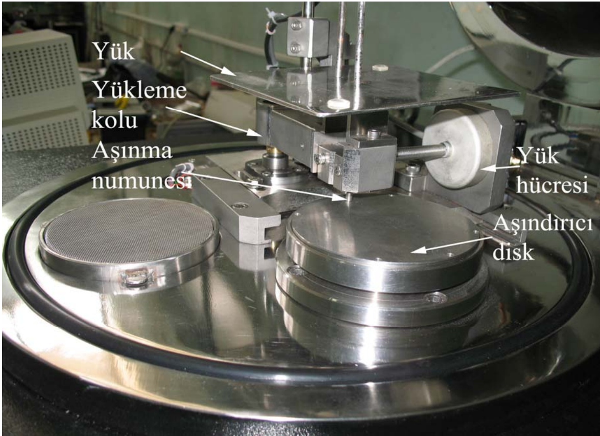
Şekil 18. Aşınma deney düzeneğinde deneylerin gerçekleştirildiği kısmın fotoğrafı
