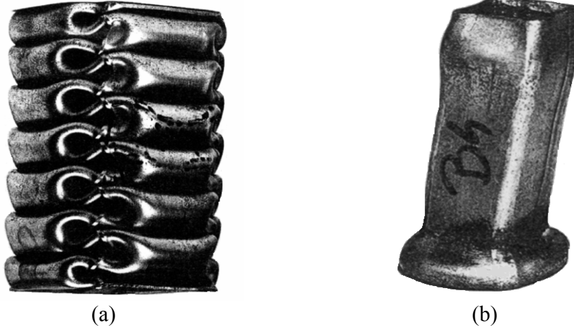
Şekil 1.3. Kare kesitli tüpler tüplerin aksel deformasyon modları [13], (a) Simetrik, (b) Aksel simetrik
