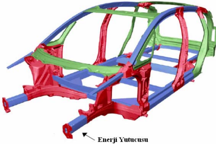
Şekil 1.1. Bir araca ait iskelet yapısı ve enerji sönümlenme elemanları [1].
