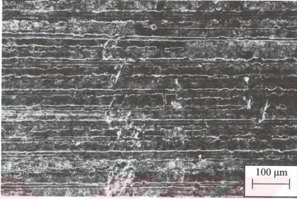
Şekil 45. Stabilize edilmiş Zn-40Al-2Cu-5Si alaşımının aşınma yüzeyinin SEM fotoğrafı.
