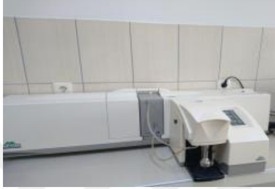
Şekil 2.5. Malvern Master Sizer 2000 tane boyut dağılım analiz cihazı
