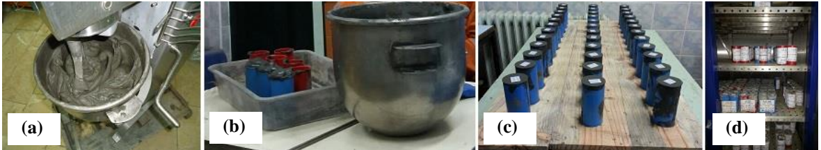
Şekil 2.11. ÇMD numunelerinin hazırlık süreci; mikserde karıştırma (a), kalıplara doldurma (b), drenaj işlemi (c) ve kür işlemi (d)
