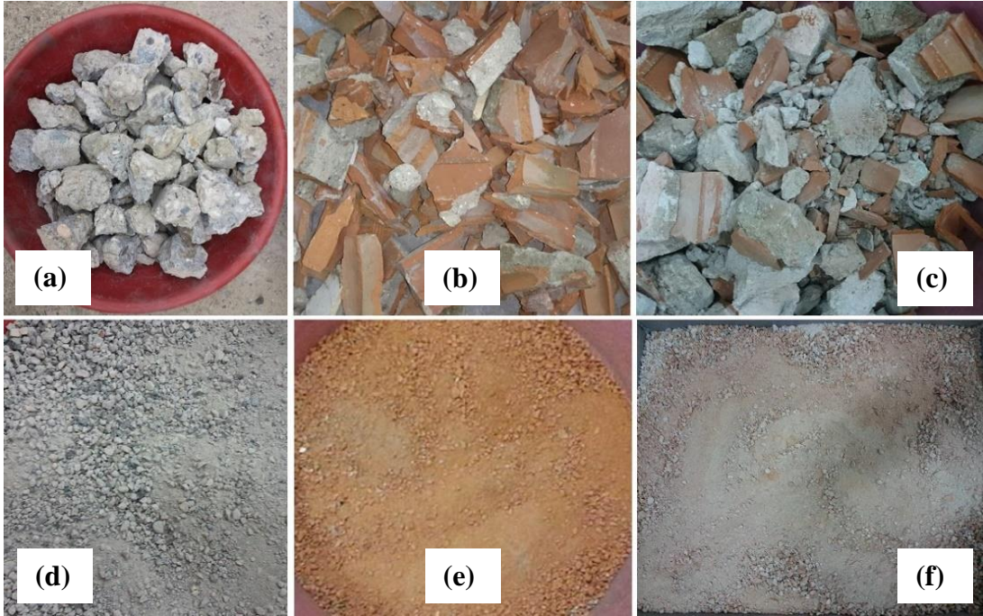
Şekil 2.5. İYA'nın çeneli kırıcı öncesi (a,b,c) ve sonrası (d,e,f) görüntüleri; beton-agrega karışımı (a,d), beton-tuğla-kiremit karışımı (b,e) ve harç-tuğla-beton karışımı (c,f)
