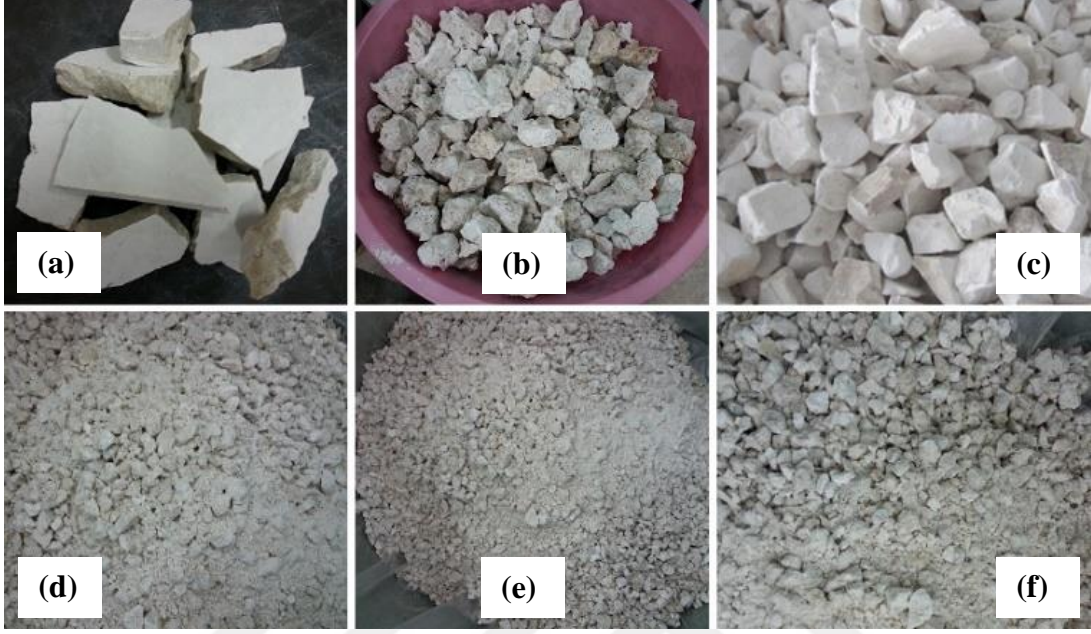
Şekil 2.4. MA (a,d), KK (b,e) ve DK'nın (c,f) çeneli kırıcı öncesi (a,b,c) ve sonrası (d,e,f) görüntüleri
