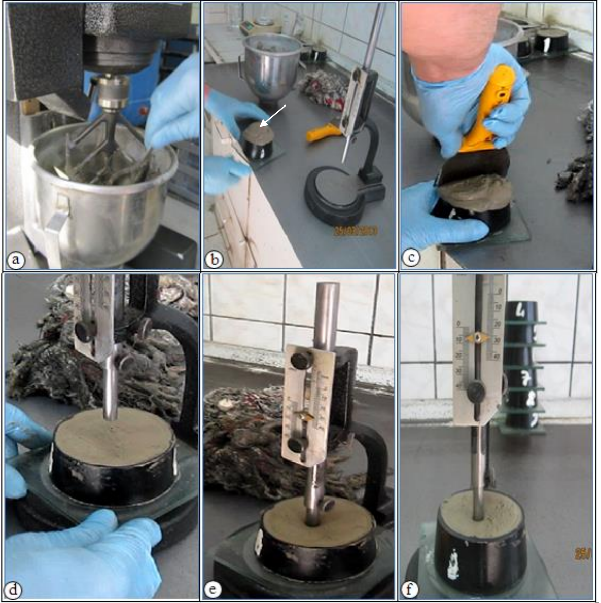
Şekil 2.16. Standart kıvam tayini; a) malzemelerin karıştırılması, b) karışımın yağlanmış numune kabına yerleştirilmesi, c) kap içerisindeki numunenin yüzeyinin düzeltilmesi, d) numunenin vicat cihazına yerleştirilmesi, e) sondanın bırakılması, f) uygun batma değerinin okunması
