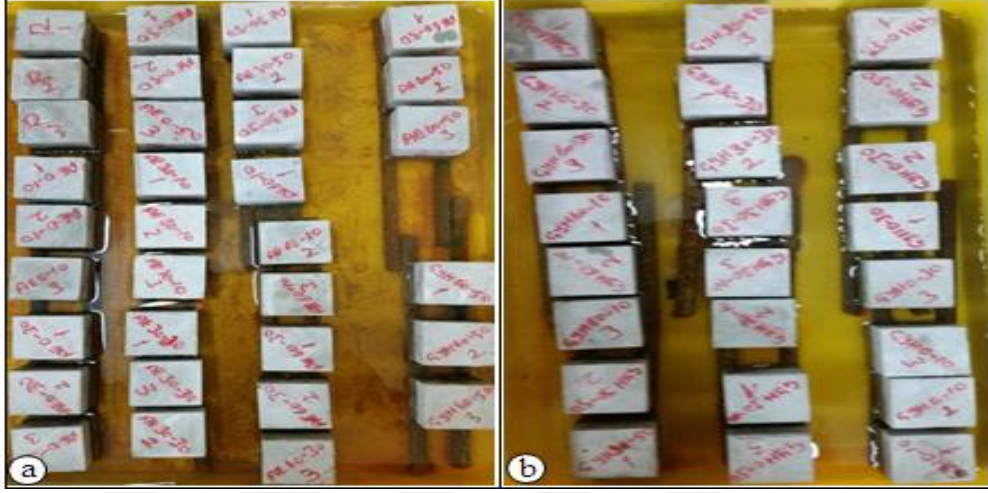
Şekil 2.22. Kapilarite deneyi; a) Afşin Elbistan uçucu kül ikameli numuneler, b) Çayırhan uçucu kül ikameli numuneler
