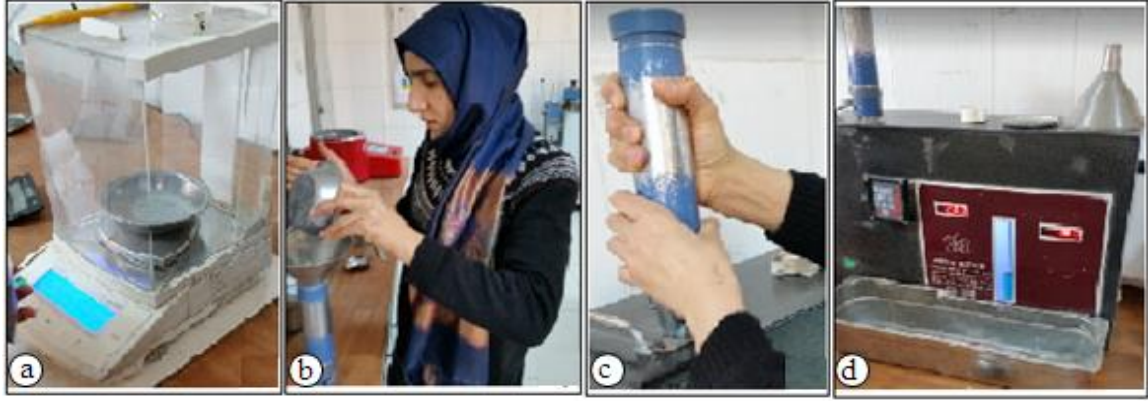
Şekil 2.5. Uçucu küllerin özgül yüzey alanı; a) numune tartımı, b) numunenin hazneye yerleştirilmesi, c) haznenin cihaza yerleştirilmesi, d) özgül yüzey alan (blaine) değerinin okunması
