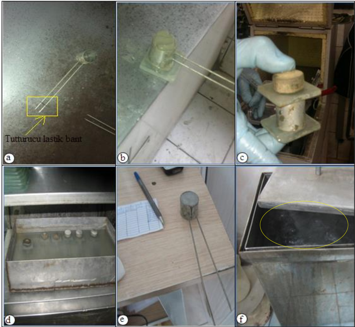
Şekil 2.18. Hacim genişleme deneyi; a) numune kabının hazırlanması, b) karışımın kalıba doldurulması, c) kalıp üzerine ağırlık koyulması, d) kür dolabında bekletilmesi, e) kür süresi sonrası ilk ölçümün alınması, f) numunenin kazanda kaynatılması
