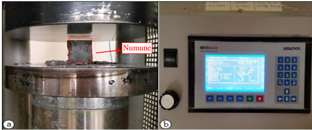
Şekil 2.20. Basınç dayanımı; a) numunenin kırılması, b) cihaz göstergesi
