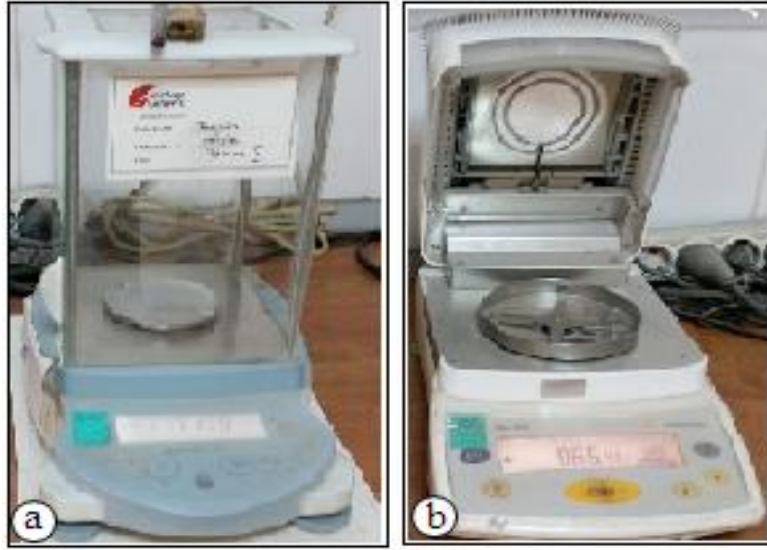
Şekil 2.6. Uçucu küllerin rutubet (nem) tayini; a) numunenin tartılması, b) nem değerinin okunması
