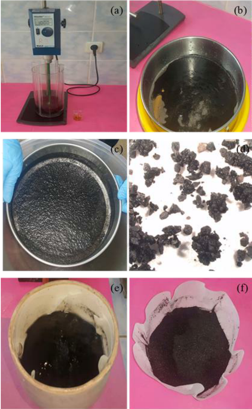
Şekil 2.8. Aglomerasyon test görüntüleri ve aşamaları (a) karıştırma, (b) aglomerat kazanımı, (c) aglomeratların yıkanması, (d) aglomeratların yakından görünümü, (e) vakum filtrede aglomeratların yağından arındırılması ve susuzlandırma, (f) yağsız temiz kömür.
