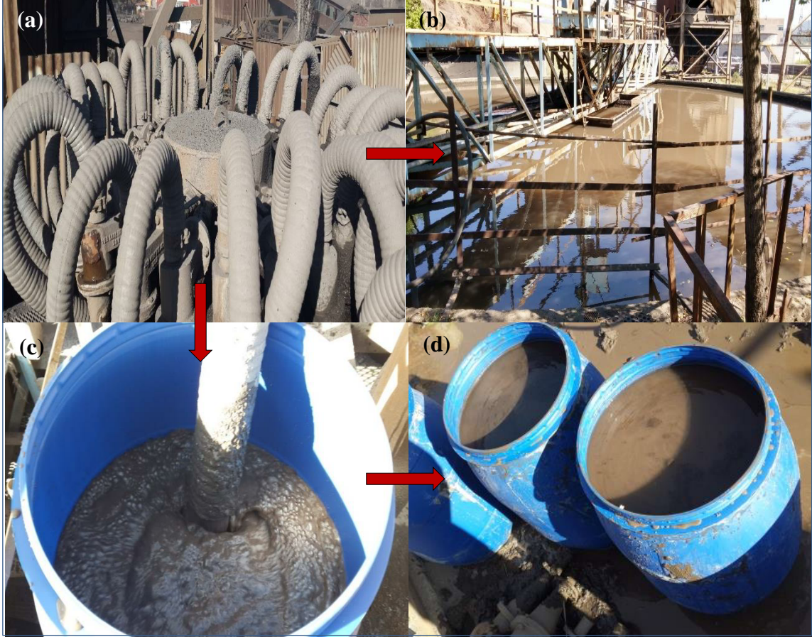
Şekil 2.2. (a) Hidrosiklon (b) Tikiner (c) Hidrosiklondan alınan atık kömür (d) Laboratuvara götürülmek üzere hazırlanan atık kömürler.
