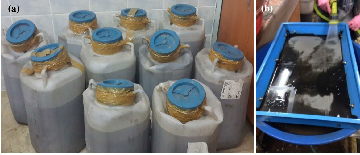
Şekil 2.3. (a) Numunelerin laboratuvara getirilmesi (b) yaş eleme
