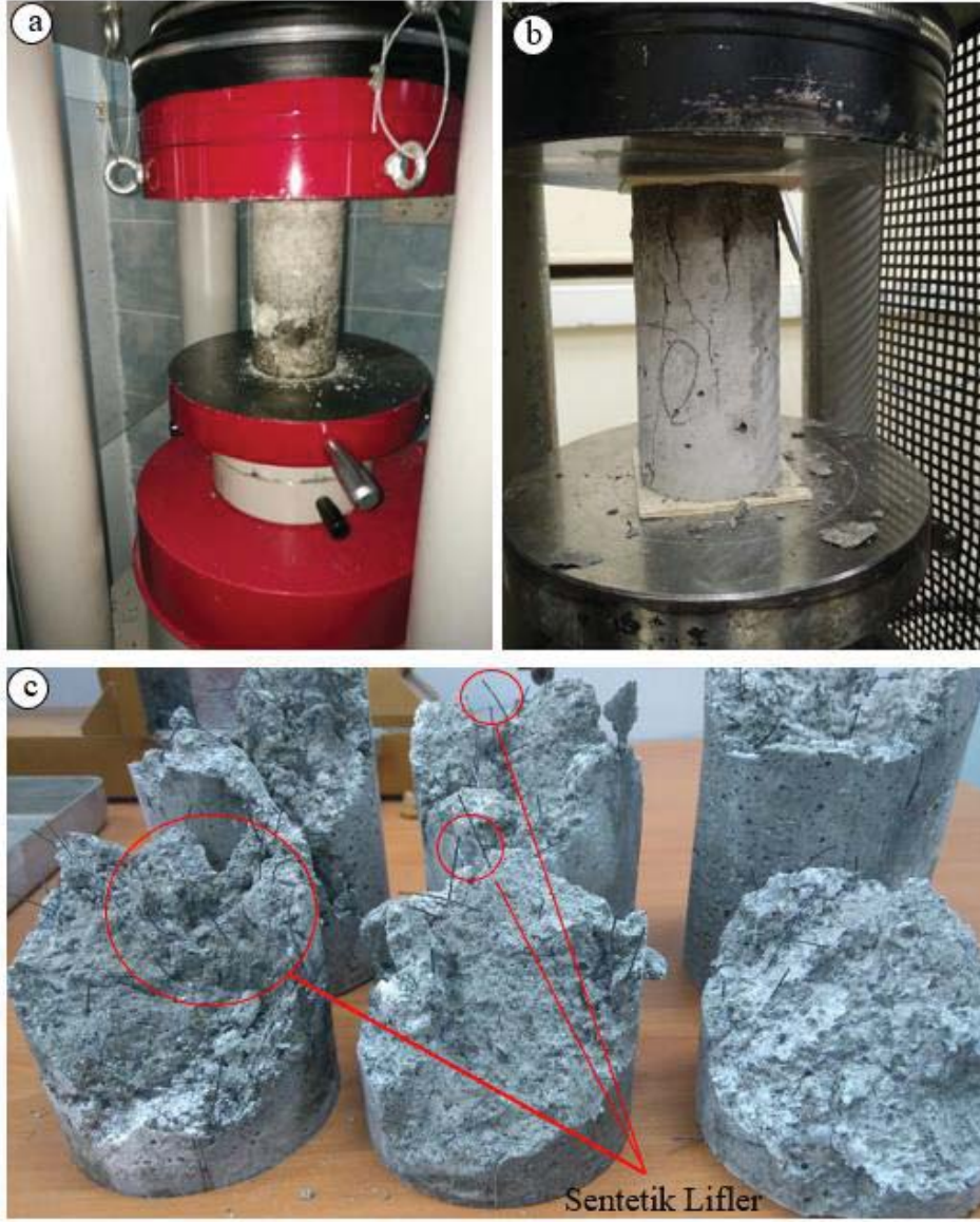
řekil 2.38. Tek eksenli basıncı dayanım deneyi a, b) silindir numuneler, c) kırılmıř numunelerin ierisindeki sentetik lifler
