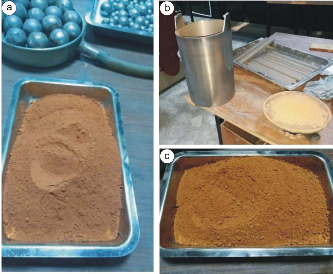
Şekil 2.9. Pişmiş kilin öğütülmesi a) bilyeli ve b) çubuklu değirmen kullanarak pişmiş kil numunesinin c) uygun boyuta getirilmesi
