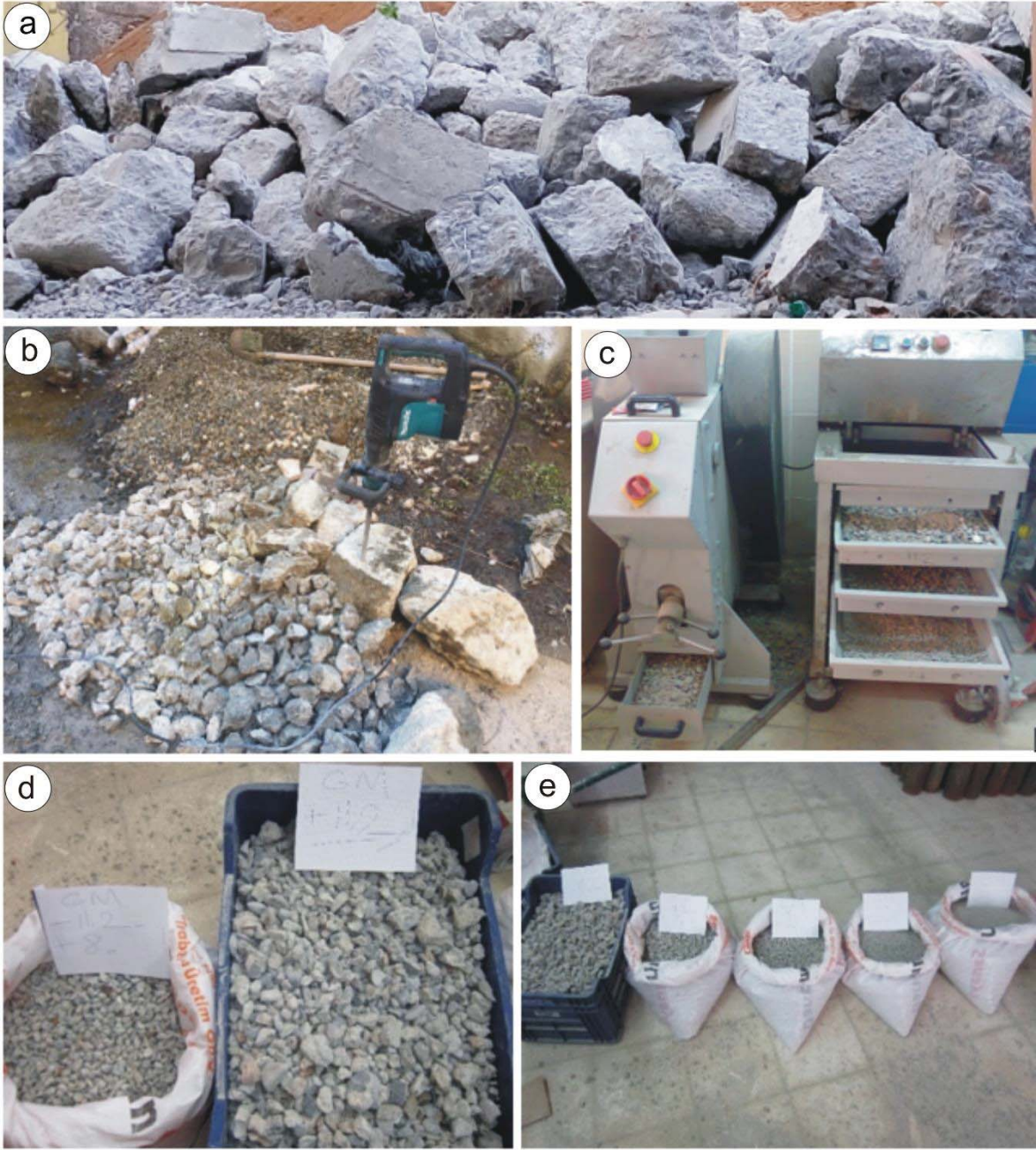
Şekil 2.5. GKA sınıflandırılması a) Laboratuvara getirilen beton molozların b) hilti ve çeneli kırıcı yardımı ile boyutlarının küçültülmesi, c, d, e) elenerek sınıflandırılması
