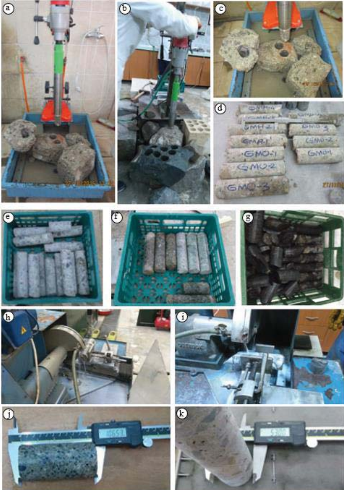
Şekil 2.15. Atık betonlar, a, b, c, d) Beton molozlarından karot alınması, e, f, g) alınan karotların sandıklanması ve h, i, j, k) boy çap oranı ayarlanarak kesilmesi
