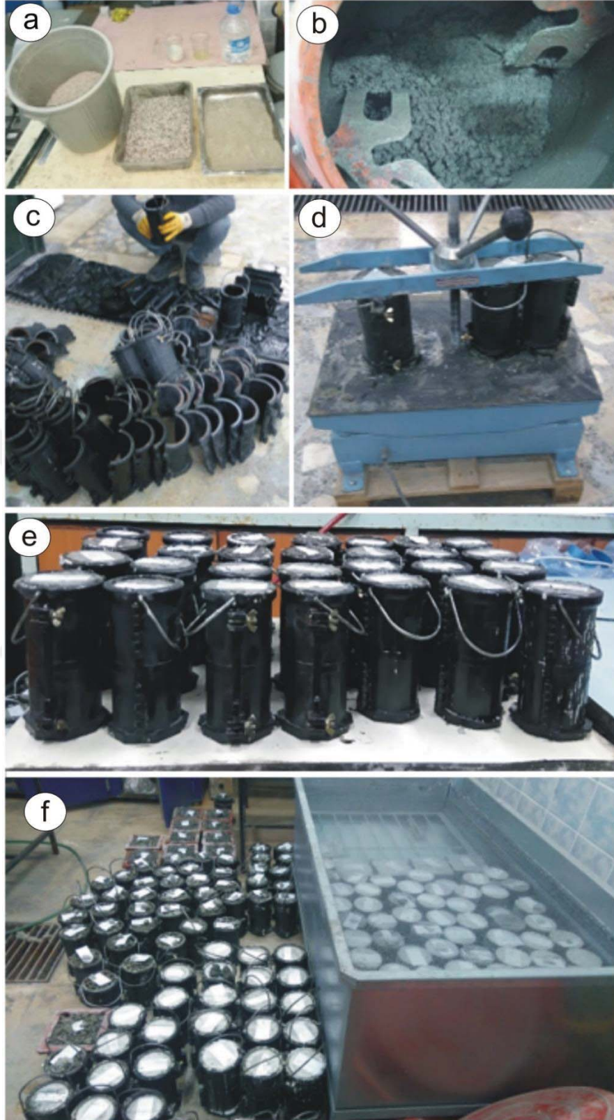
Şekil 2.35. Silindir numune dökümü a) Dökümde kullanılan malzemeler, b) Mikserde karıştırma işlemi, c) kalıpların yağlanması, d, e) silindir numunelerin dökümü ve sıkıştırılması, (f) numunelerin kalıptan çıkarılarak kür tankına yerleştirilmesi
