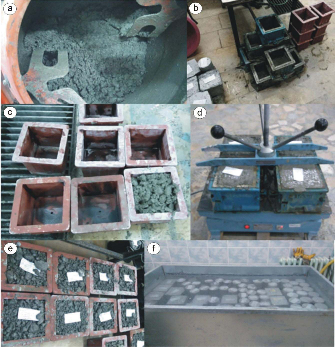
Şekil 2.45. Dolgu deneyleri a) Küp dökümler için karışımın karıştırılması, b) küp kalıplarının hazırlanması, c, d, e), küplerin doldurulması ve sıkılama işlemi, f) numunelerin kür havuzuna konulması
