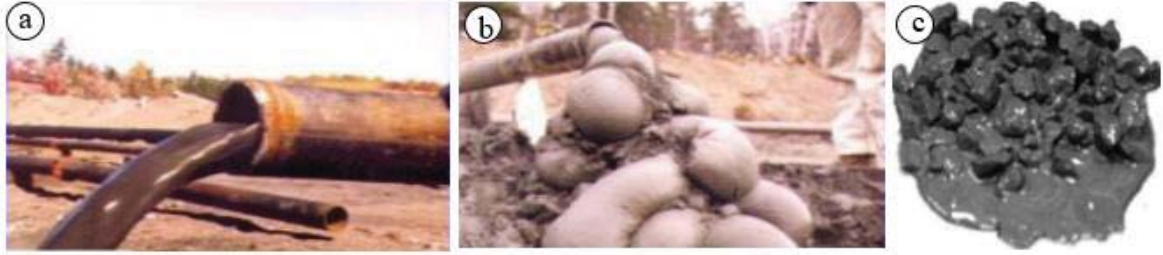
Şekil 1.5. Yeraltında kullanılan dolgu yöntemleri, a) hidrolik dolgu, b) macun dolgu, c) kaya dolgu (URL-1).
