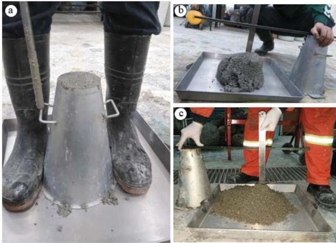
Şekil 2.36. (a) Çökme testi deneyi, (b) kıvamı uygun ve (c) uygun olmayan döküm
