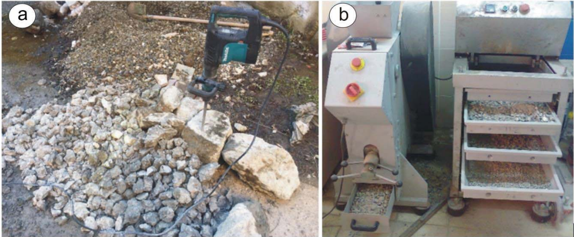
Şekil 2.22. İnşaat molozlarının sınıflanması a). molozların boyut küçültme ve b) eleme işlemi
