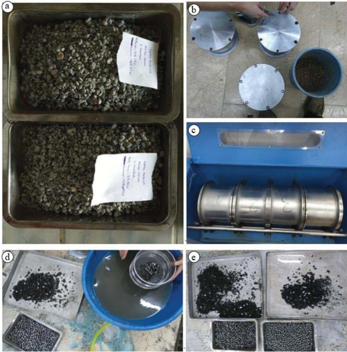
Şekil 2.33. Mikro- Deval aşınma deneyi, a) deney için uygun boyutta GKA, b, d) haznelerin sökülmesi ve deney düzeneği, c, e) deney sonrası eleme işlemi
