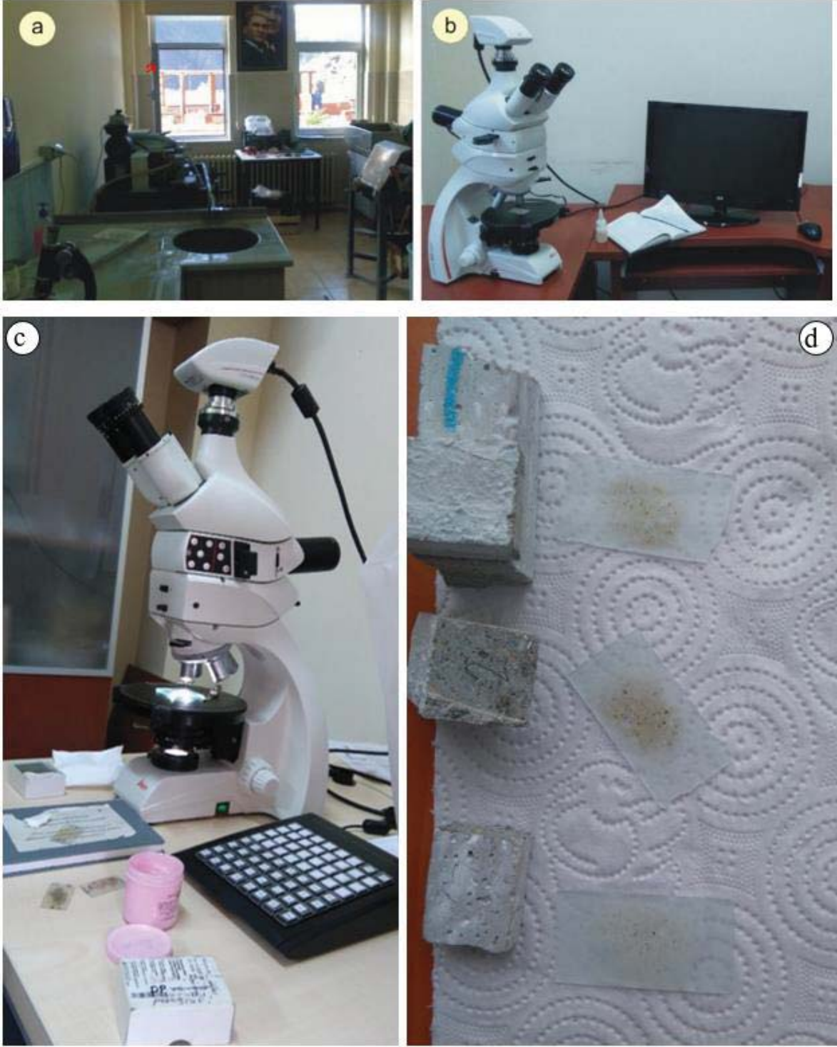
Şekil 2.44. İnce kesit analizi a) İnce kesit laboratuvarı, b) Araştırma mikroskobu ve c), görüntü işleme, d) oluşturulan ince kesitler
