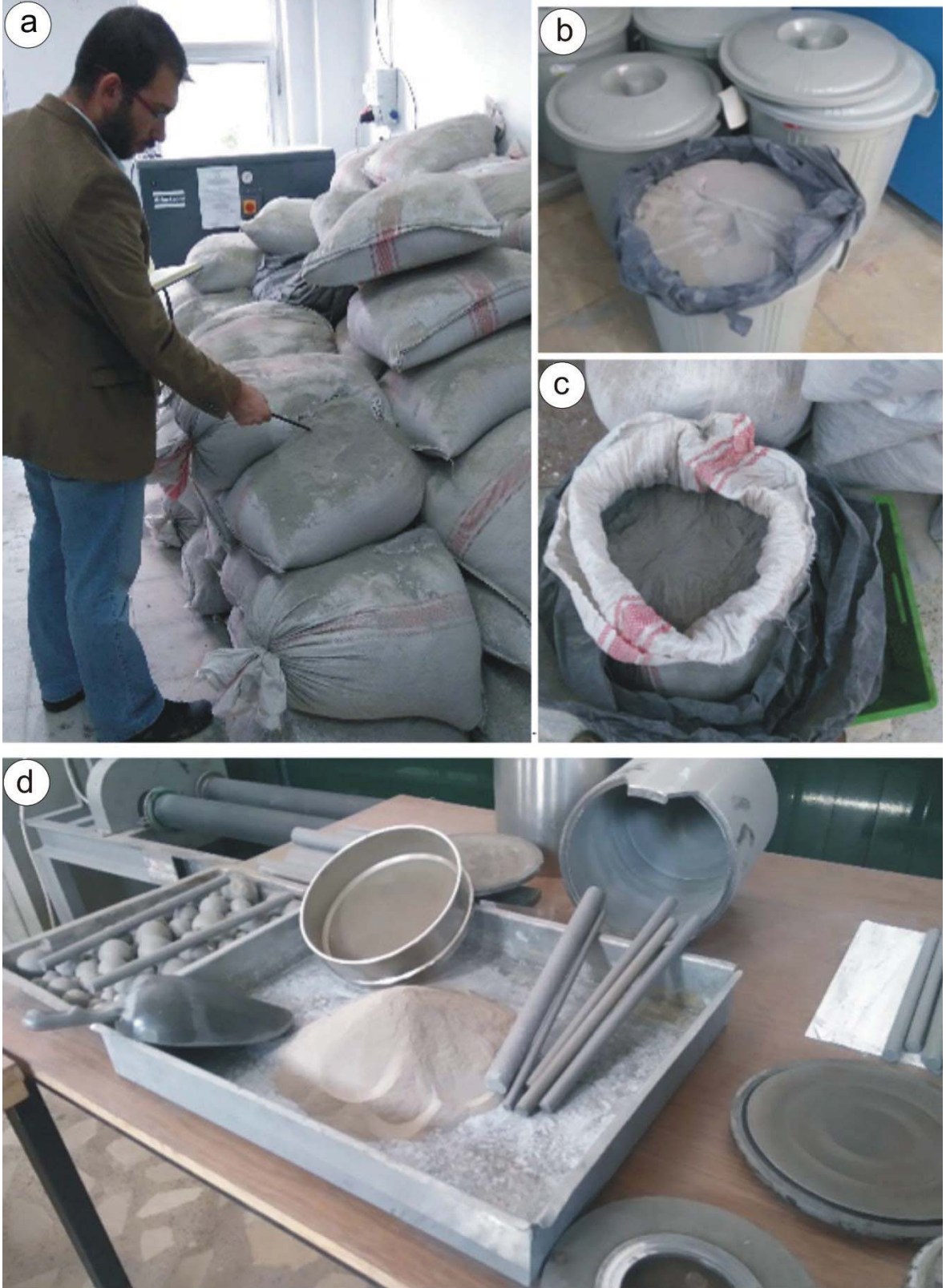
Şekil 2.7. Uçucu kül, a, b, c) Uçucu külün laboratuvarda depolanması, d) bilyeli ve çubuklu değirmen yardımı ile uygun boyuta getirilmesi
