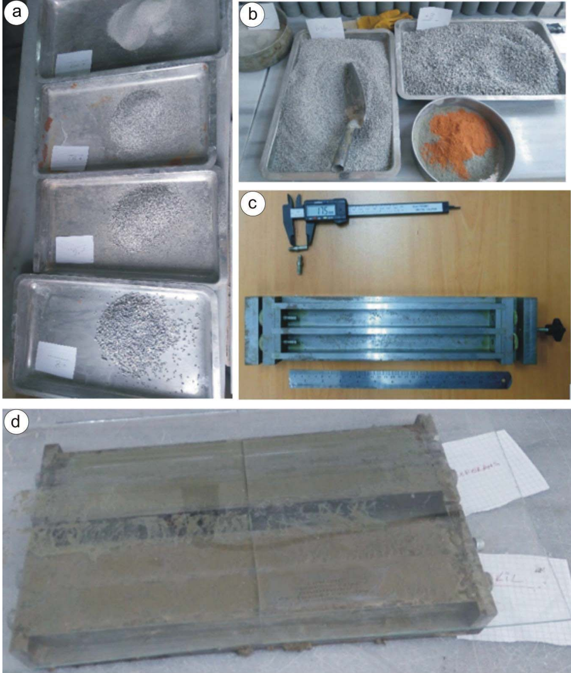
Şekil 2.29. Alkali silika reaksiyonu deneyi a, b) karışımda kullanılan malzemeler, c) ikili harç çubuğu kalıpları, d) harç çubuklarının dökülmesi
