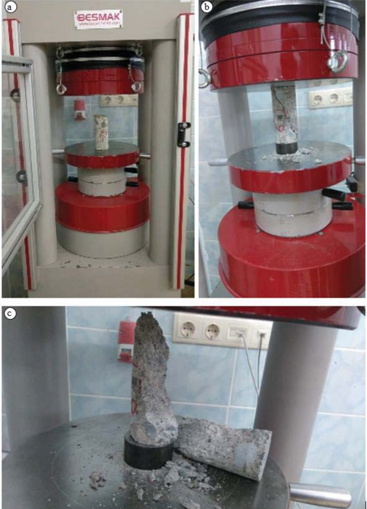
Şekil 2.17. İnşaat moloz karotlarının a) tek eksenli basınç dayanım deneyi ve b, c) kırılma şekilleri
