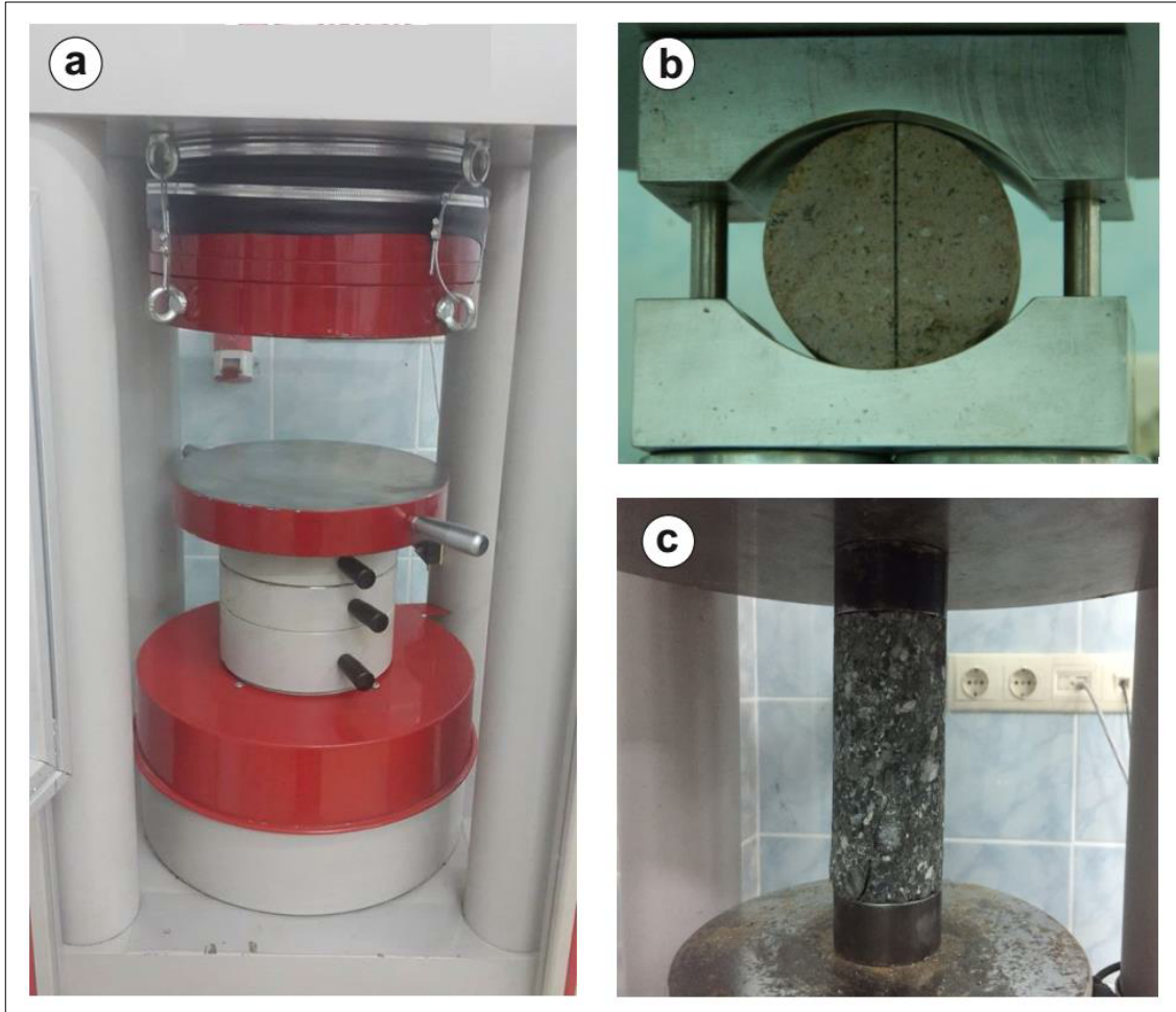
Şekil 2.17. (a) 200 ton kapasiteye sahip hidrolik basınç test makinesi (b) Dolaylı çekme dayanımı deneylerinde kullanılan çene (c) Test makinesinde tek eksenli basınç deneyi
