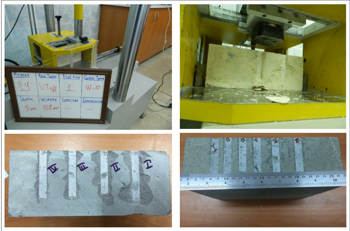
Şekil 2.23. Basit kama tipi kesimler ile yapılan kesme deneylerinin ve kesilen numunelerinin görüntüleri
