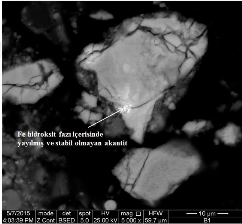
Şekil 126. KOH liçi ardından gerçekleştirilen BSE görüntüsü a) Aglomerat içerisinde akantit, b) Fe hidroksit fazı içerisinde akantit
