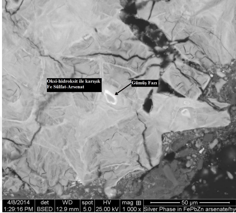
Şekil 50. + 200 µm fraksiyonunda, Ag içeren bir Fe oksihidroksit ile sülfat–arsenat karışımını gösteren BSE görüntüsü
