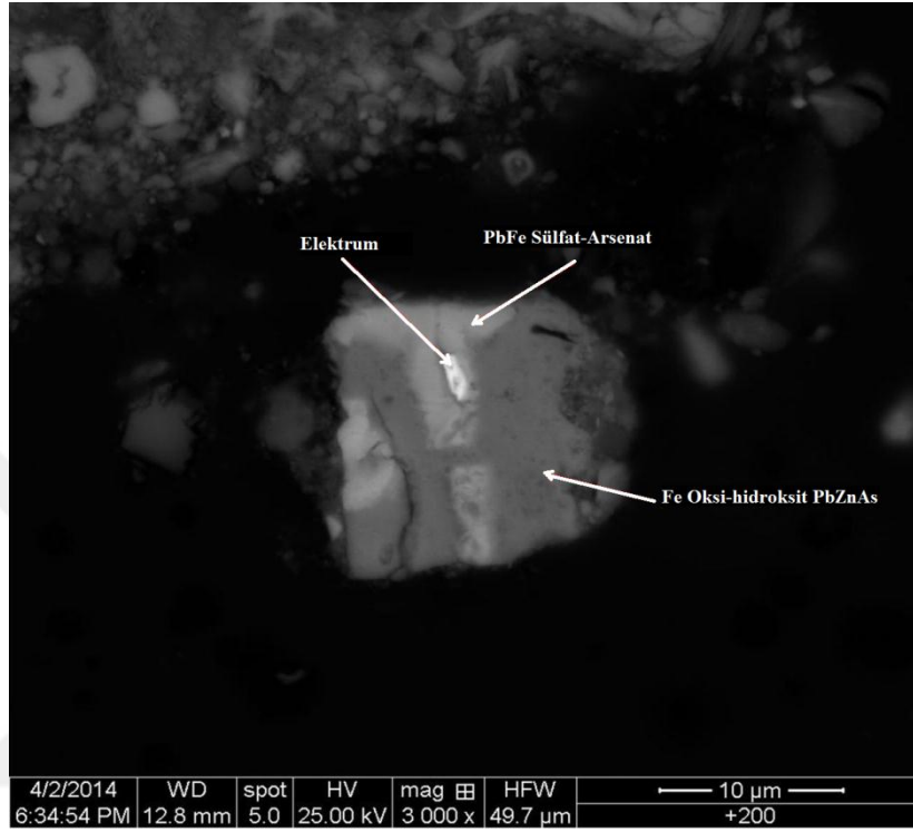
Şekil 42. + 200 µm fraksiyonunda, bir Fe oksihidroksit parçacığında, PbFe sülfat–arsenat ile ilişkili elektrümü gösteren BSE görüntüsü
