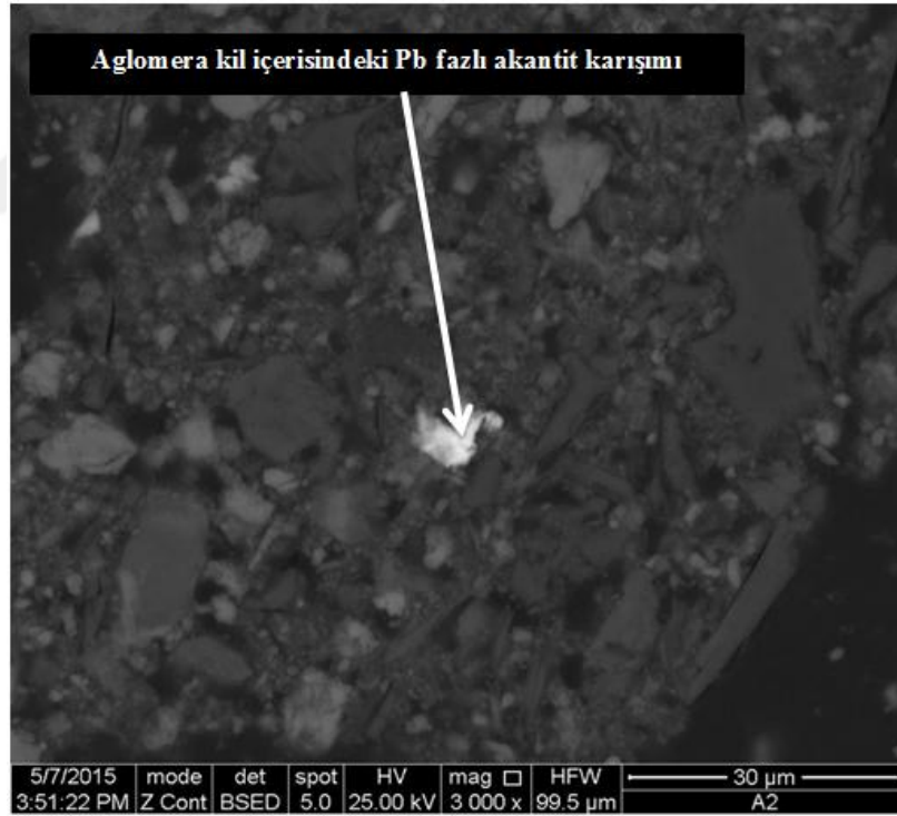
Şekil 106. NaOH+CN liçi ardından gerçekleştirilmiş BSE görüntüsünde a) Fe oksit/hidroksitler, kil ve karbonatların görünümü, b) Aglomera kil içerisindeki Pb fazlı akantit karışımı
