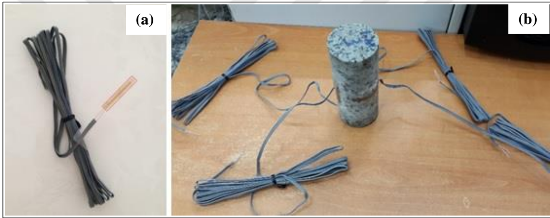
Şekil 2.4. TML deformasyon ölçer (a) ve deformasyon ölçer yapıştırılmış numunenin görünümü (b)
