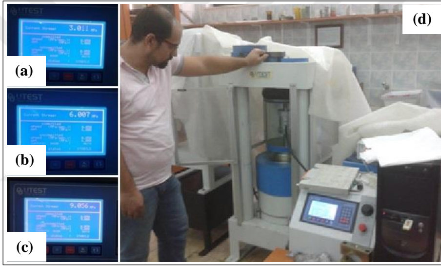
Şekil 2.6. ÜEBD deneyinde yanıl basınçlar 3 MPa (a), 6 MPa (b), 9 MPa (c) ve ÜEBD test ünitesi (d)
