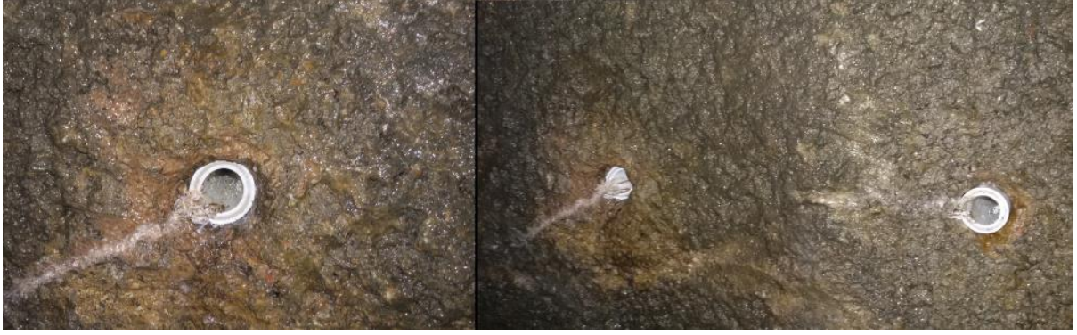
Şekil 3.8. Delik içerisinden çekme kuvveti ile gövdesi yenilmiş PP-R kompozit tüpler
