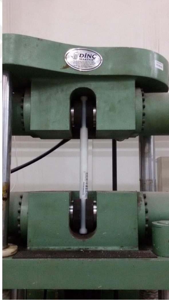
Şekil 2.23. Poliamid saplama çekme testi
