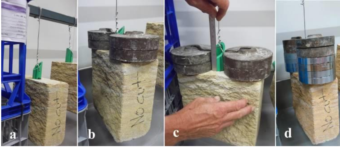
Şekil 2.16. a) Askıdaki polimer saplamalı bloklar, b ve c) blok üzerine konan 15 kilogram yük, d) blok üzerindeki 39 kilogram yük
