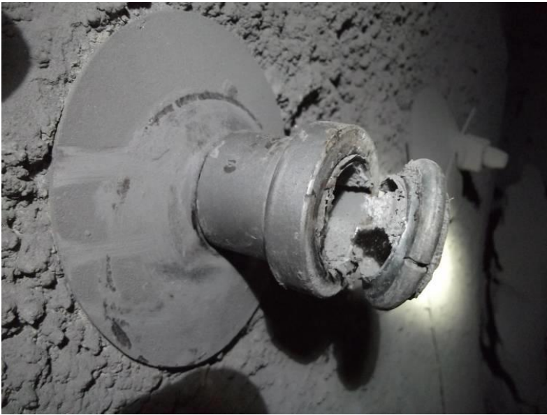
Şekil 3.2. Kırılmış split-set çeliği
