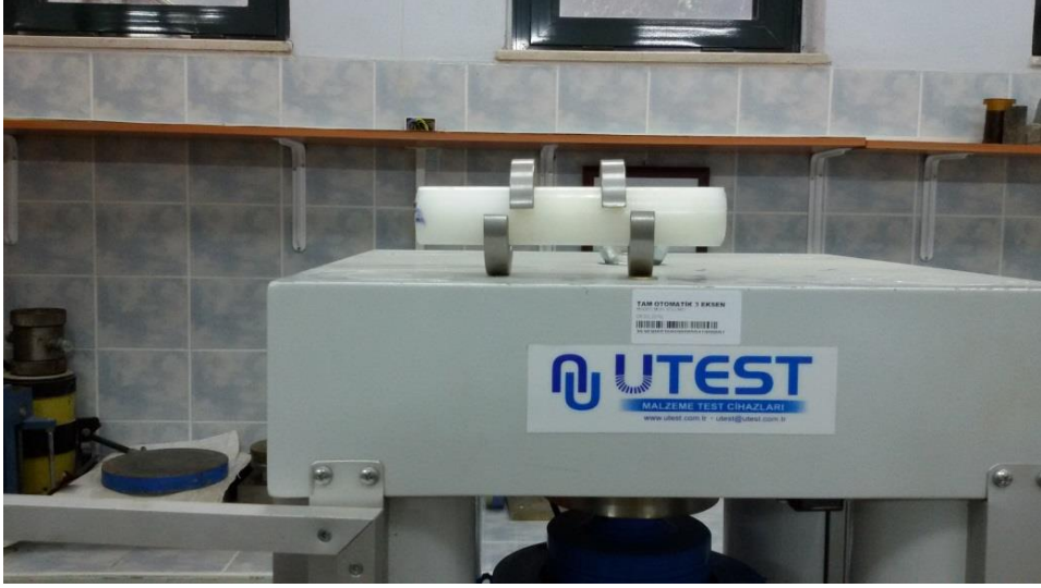
Şekil 2.25. Makaslama halkalarının poliamid rod ile kullanımları
