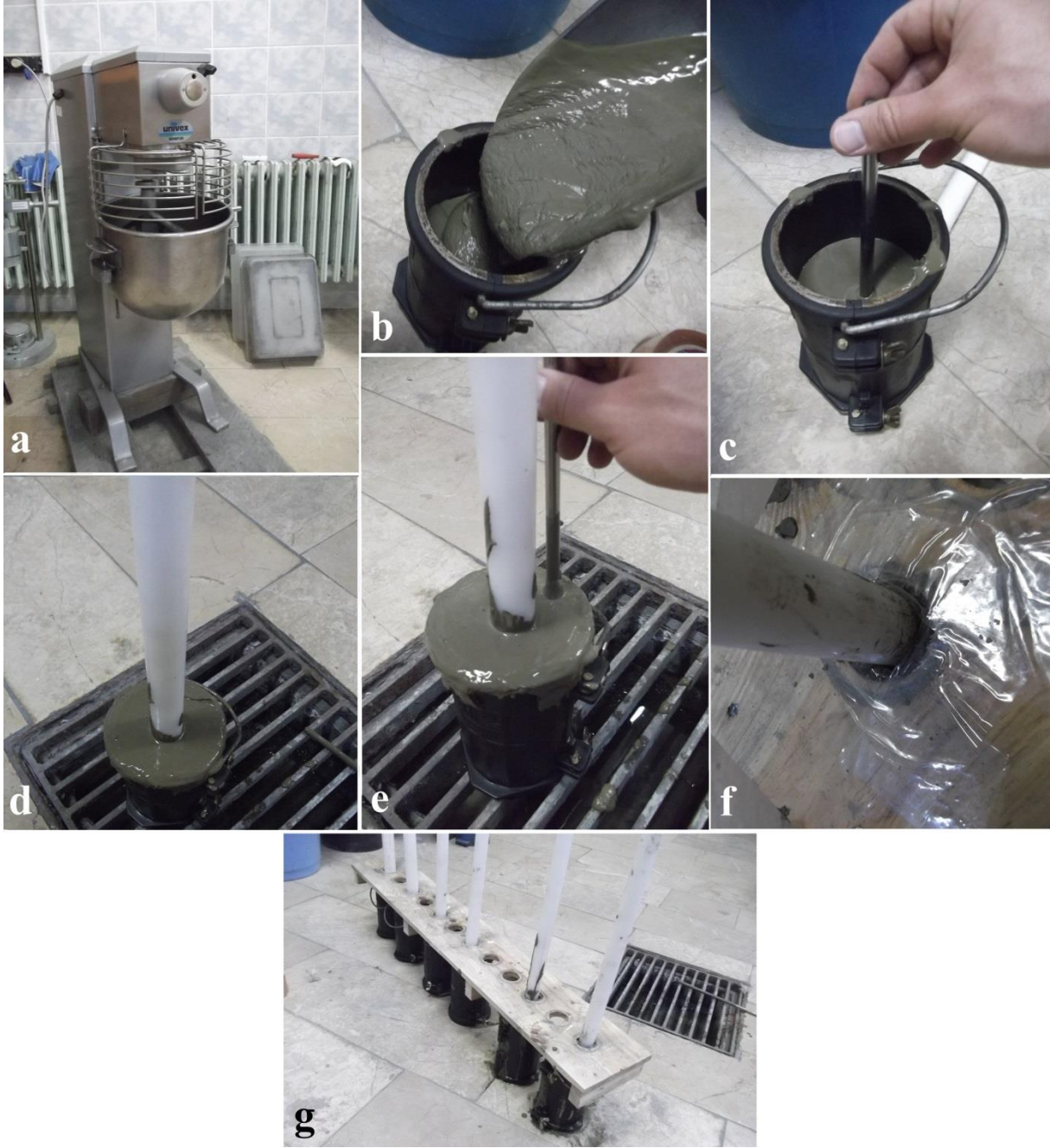
Şekil 2.30. Poliamid çekme/çıkarma numunelerinin hazırlanması: a) çimento/su karışımının hazırlandığı mikser, b) çimento enjeksiyonunun kalıplara dökülmesi, c) şişleme, d ve e) enjeksiyon içine yerleştirilmiş poliamid saplama ve tekrar şişleme, f) delikli saplama tutma sehvası ve saplamaların oynamaması için bantlanmış delik, g) saplama tutma sehvası ve enjeksiyon içerisindeki poliamid saplamalar.
