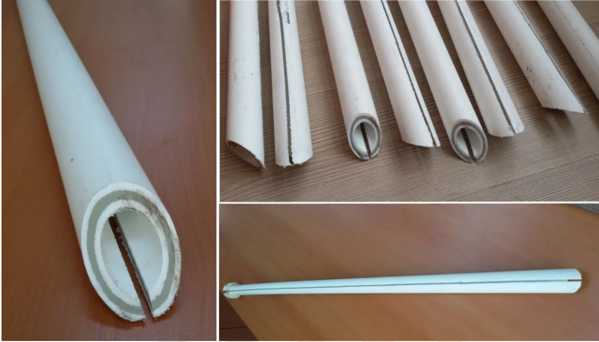
Şekil 2.19. Yeraltı testlerinde kullanılmak için hazırlanmış PP-R kompozit saplamalar
