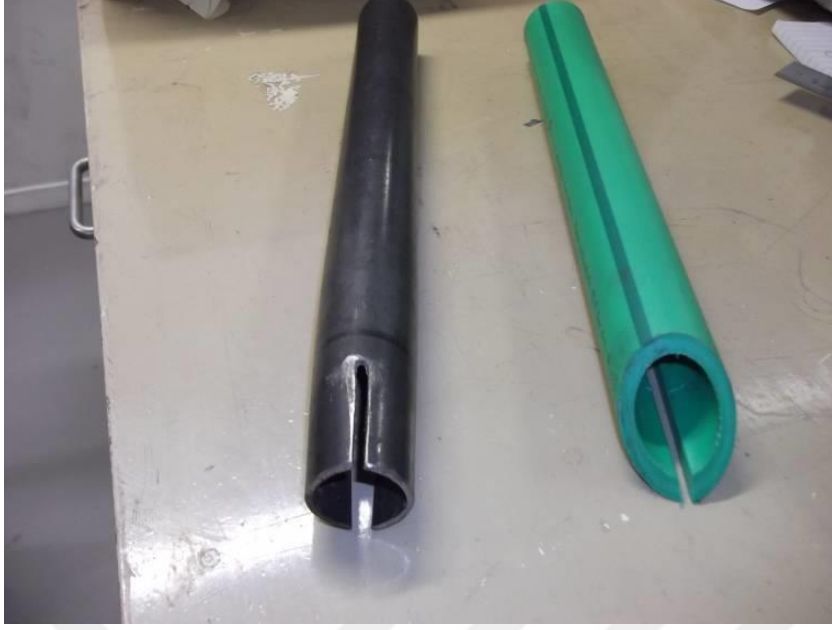
Şekil 2.9. Montaj için hazır, uçları kesilmiş çelik ve polimer saplama numuneleri
