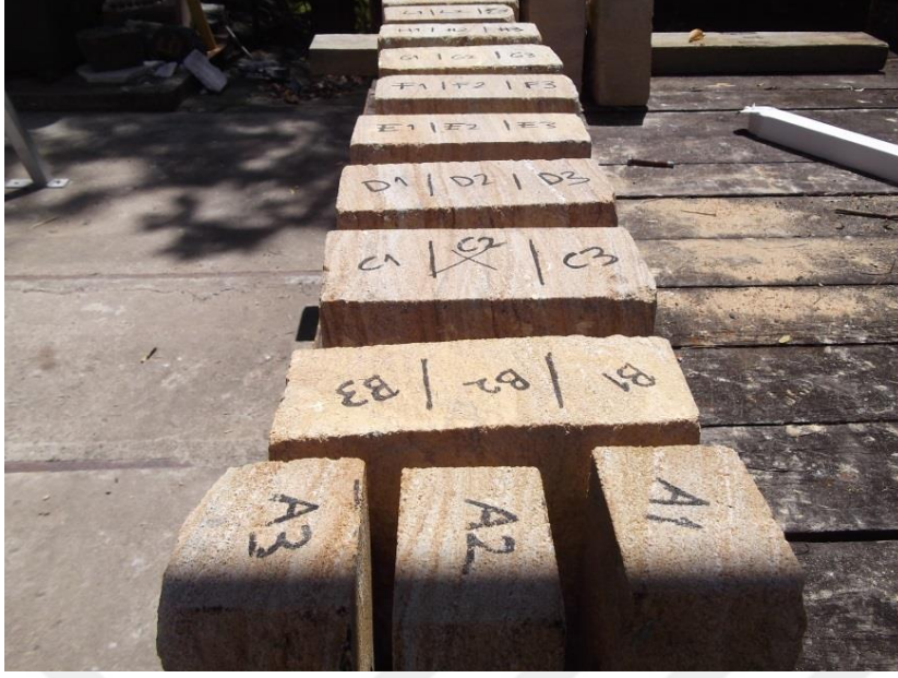
Şekil 2.7. Makaslama testi için kesilmiş ve kesilecek blok numuneler
