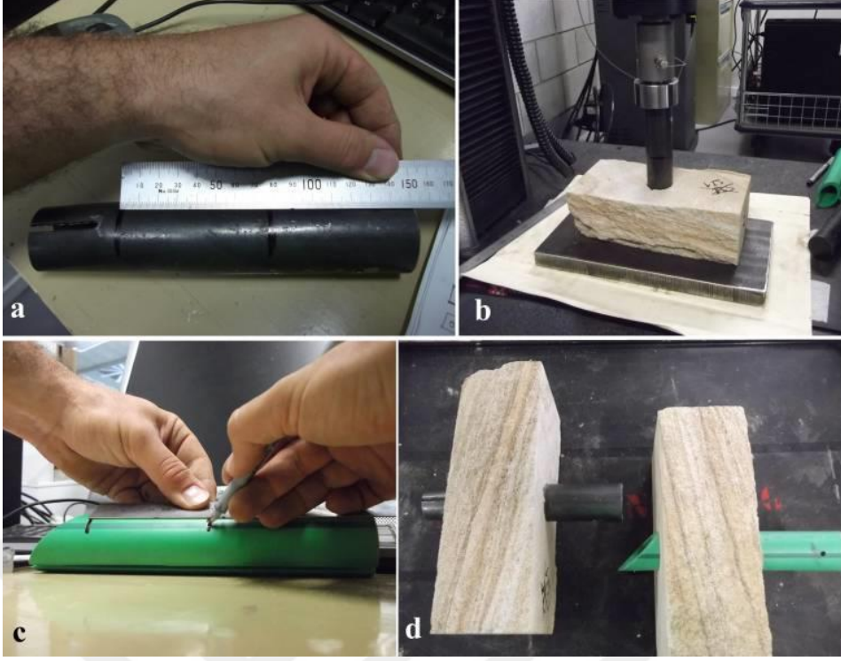
Şekil 2.17. a) Çelik split setlerin blok içinde sürtünme yüzeyi temas konumunun çizilmesi, b) çelik split set montajı, c) Polimer tüplerin blok içindeki temas konumu sınırlarının çizilmesi, d) montajı tamamlanmış çelik ve polimer tüpler
