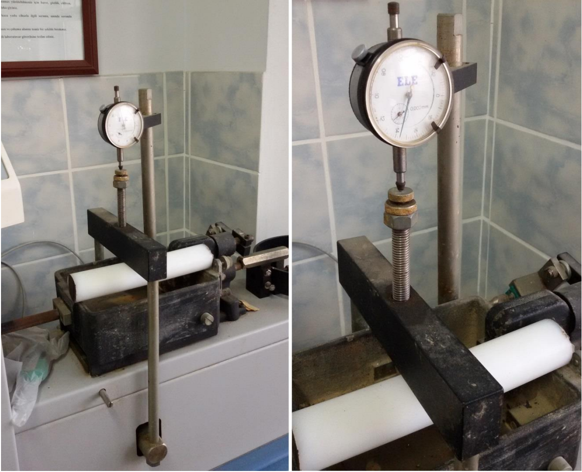
Şekil 2.29. Poliamid sünme testi
