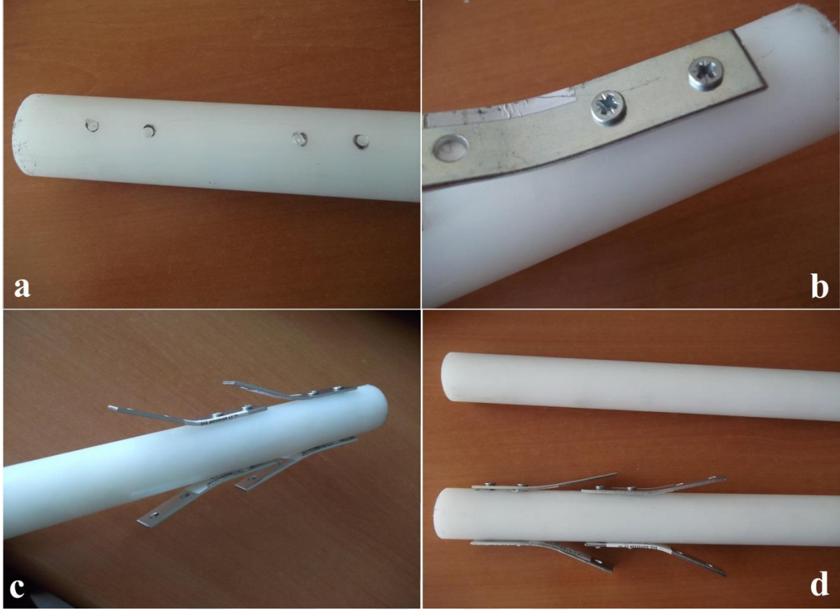
Şekil 2.31. Poliamid saplama ucundaki kanca: a) ucu delinmiş poliamid saplama, b ve c) vidalanmış kanca, d) kancalı ve kancasız poliamid sapsamalar
