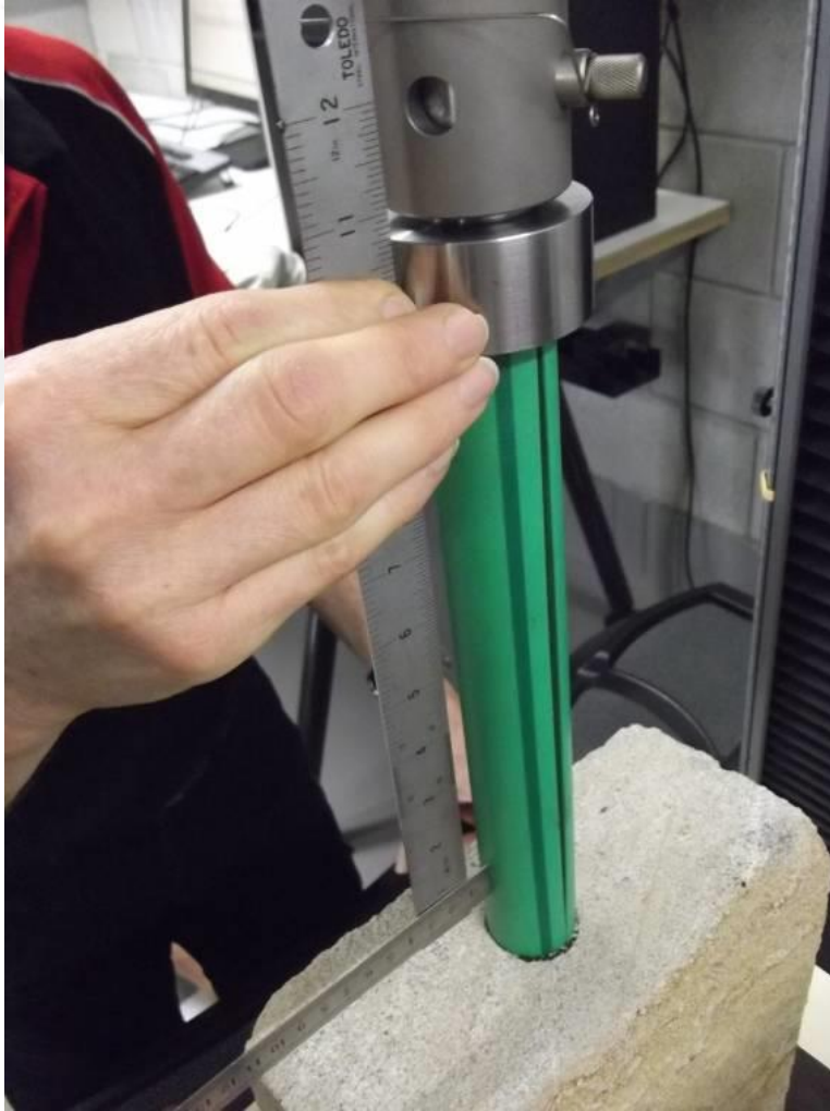
Şekil 2.11. Saplamanın düşey ile paralelliğinin kontrol edilmesi
