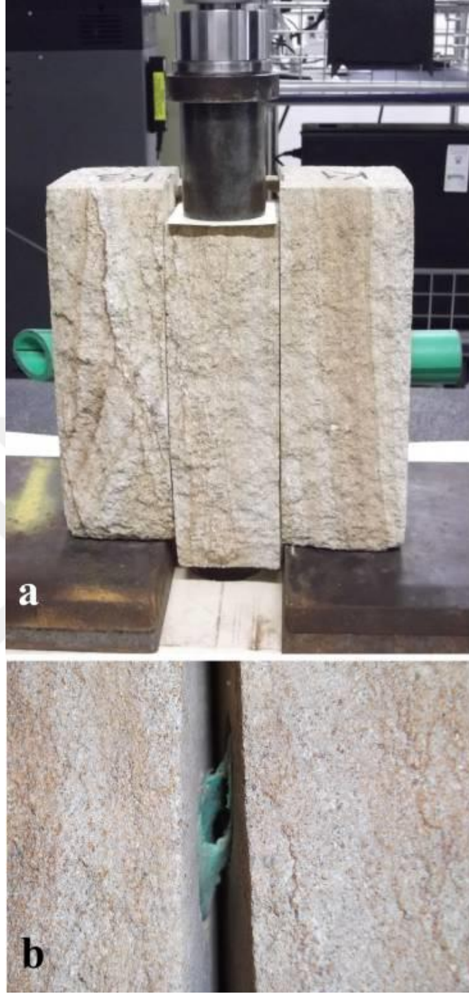
Şekil 2.14. a) Makaslama testi, b) makaslanmış polimer saplama
