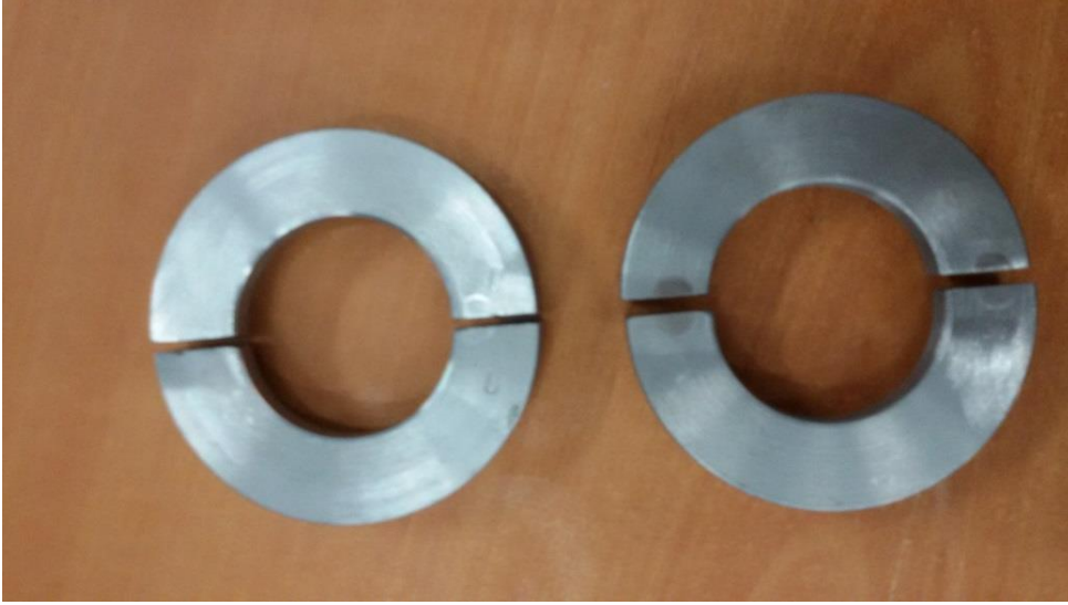
Şekil 2.24. Makaslama testlerinde kullanılan ayrılmış çelik halkalar
