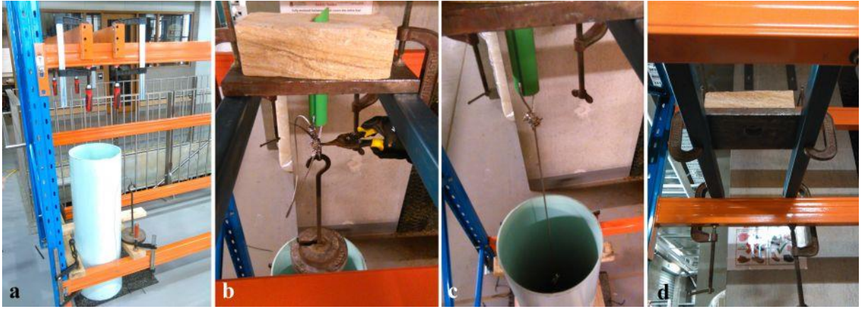
Şekil 2.18. a) Darbe testi deney düzeneği, b) plastik kelepçenin kesilmesi, c) ağırlığın düşmesi, d) kaya saplamasının sıyrılmış olduğu numune
