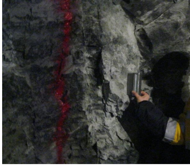
Şekil 2.15. Tünel aynasında pürüzlülük ölçümleri
