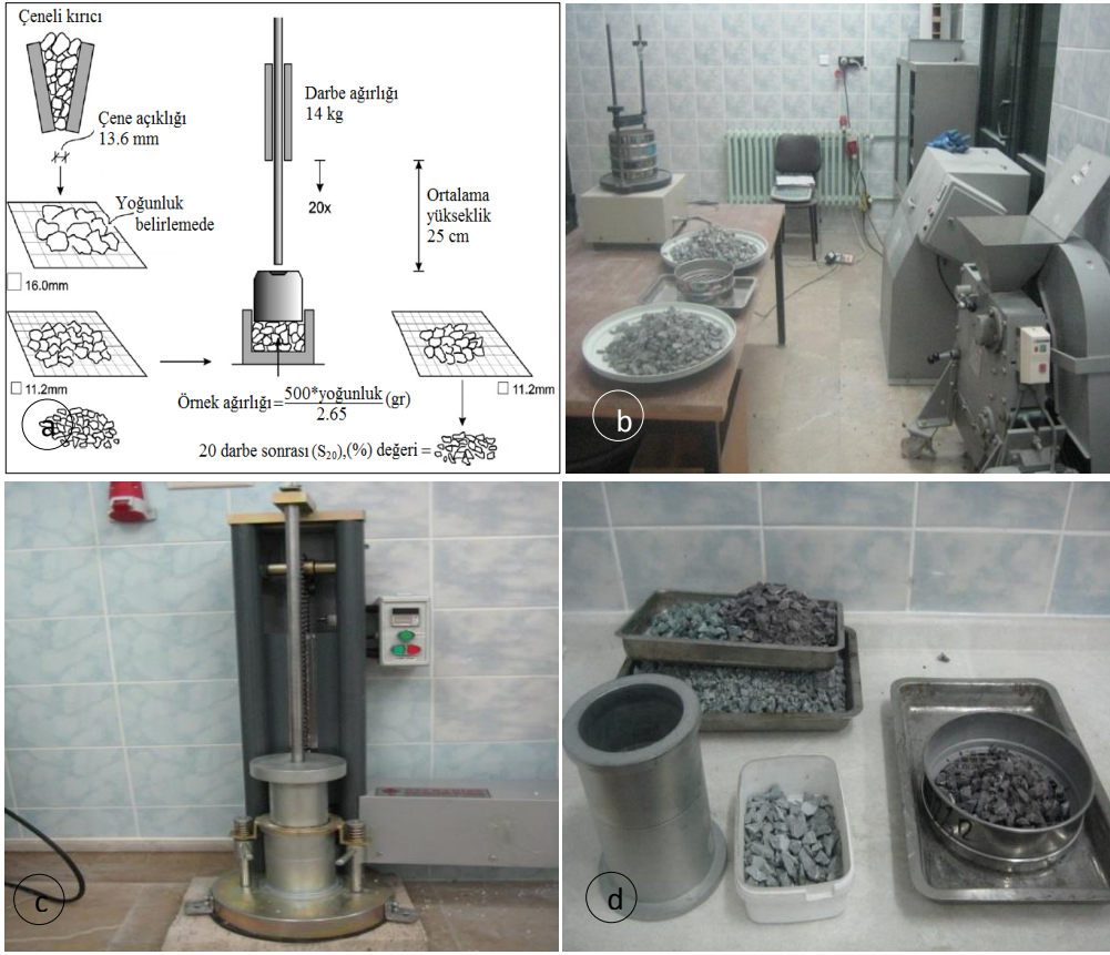
Şekil 2.39. Kırılgenlik deneyinin yapılışı, a) deney düzeneği, b) numune hazırlama, c) deney aleti
