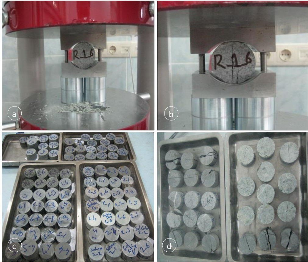
Şekil 3.9. Brazilian dolaylı çekme dayanımı, a)hazırlanmış numune b) numunenin kırılması, c) hazırlanan numuneler, d) kırılmış numuneler
