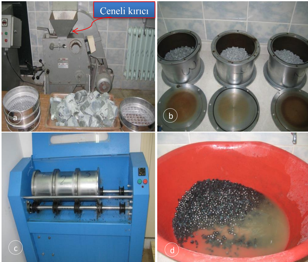
Şekil 2.38. Mikro-Deval aşınma kaybı aşamaları, a) numune hazırlama, b) numunelerin tamburlara yerleştirilmesi, c) ve d) deneyin yapılışı
