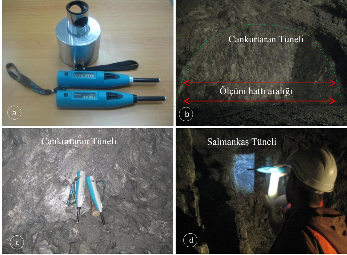
Şekil 2.24. Cankurtaran ve Salmankas Tünel kazı aynalarında kullanılan, a) L ve N tipi Schmidt çekiçleri ile (Proceq) kalibrasyon örsü, b) ölçümlerin yapıldığı hat aralığı, c) kazı aynasındaki Schmidt çekiçleri ve d) aynada ölçüm yapılması
