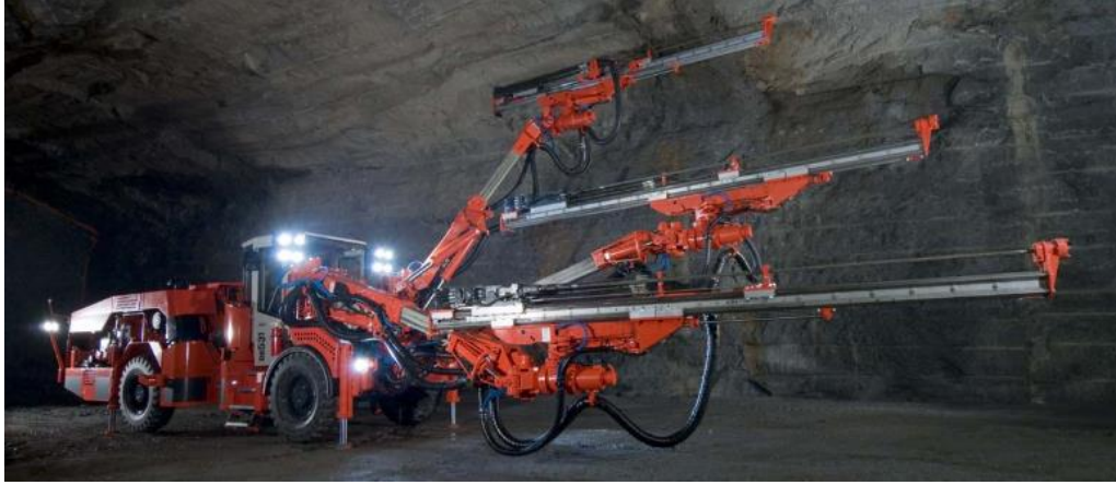
Şekil 1.30. Üç boumlu jumbo delici Sandvik DD531-S60C tipi makinesi
