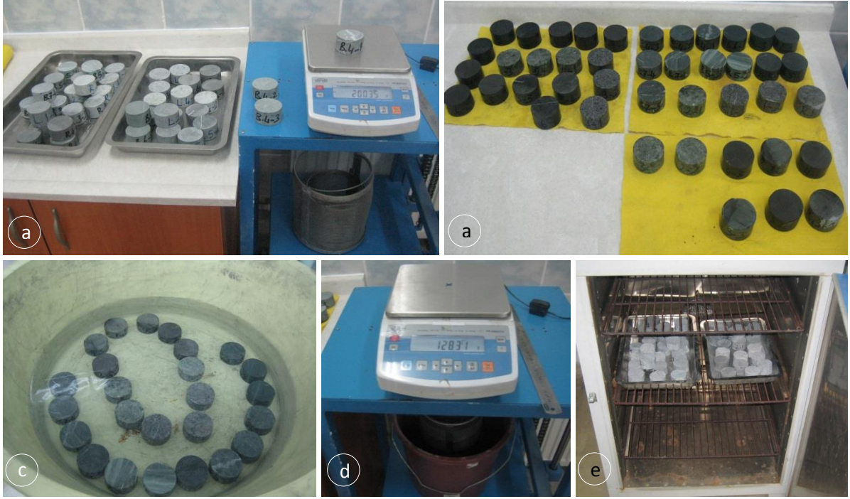
Şekil 2.31. Kayaçların fiziksel özelliklerini belirlemek için gerçekleştirilen aşamalar, a) numune tartımı, b) suya doygun numuneler, c) suya doyurma, d) Arşimet terazisiyle numune tartımı, e) fırında kurutma
