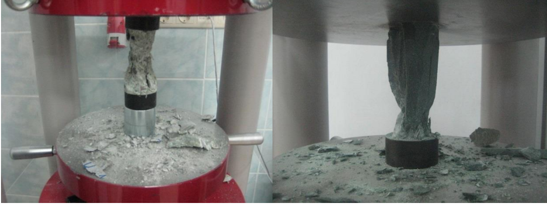
Şekil 3.5. Tek eksenli basınç dayanımı sonucunda kırılan numuneler
