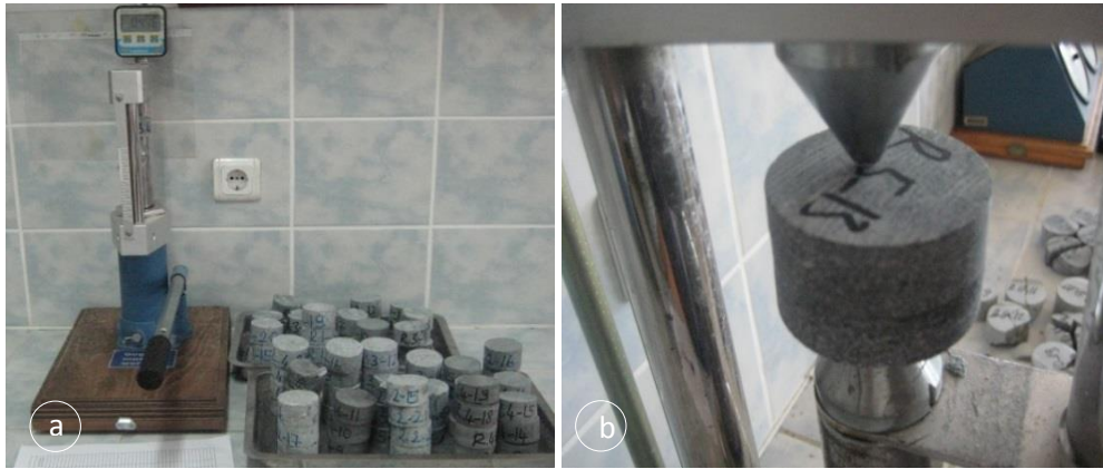
Şekil 2.34. Nokta yük deneyi, a) deney düzeneği, b) numunenin kırılması
