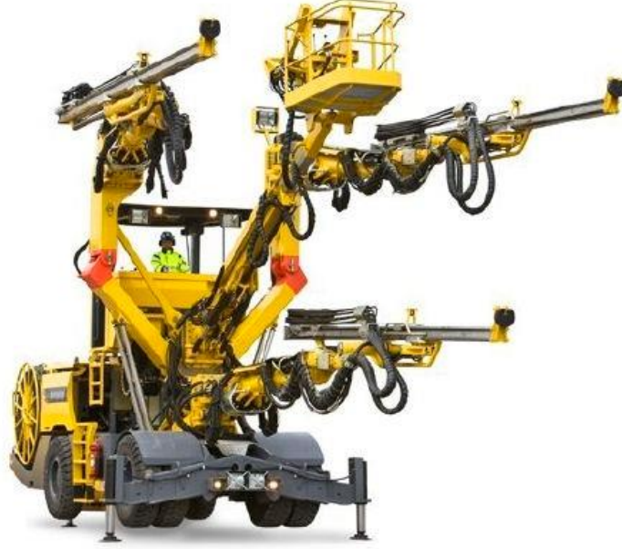
Şekil 1.29. Üç boumlu jumbo delici Atlas Copco Rocket Boomer XL3 C tipi makinesi
