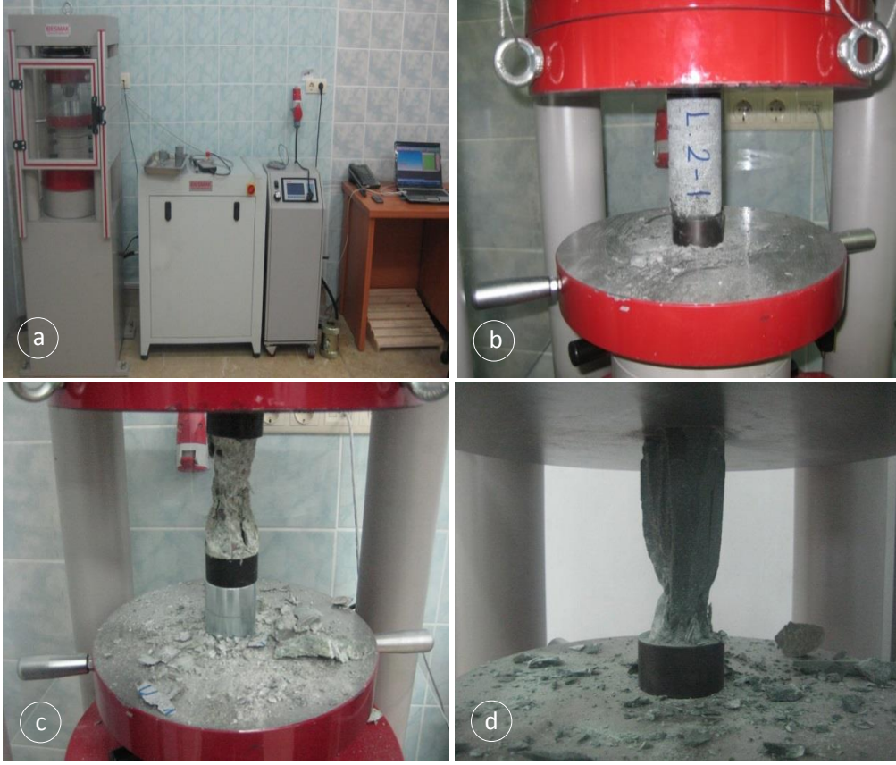
Şekil 2.33. Tek eksenli basma dayanımı deneyin yapılışı, a) deney aleti, b) hazırlanan numunenin plakalar arasında yerleştirilmesi, c) ve d) kırılan numuneler
