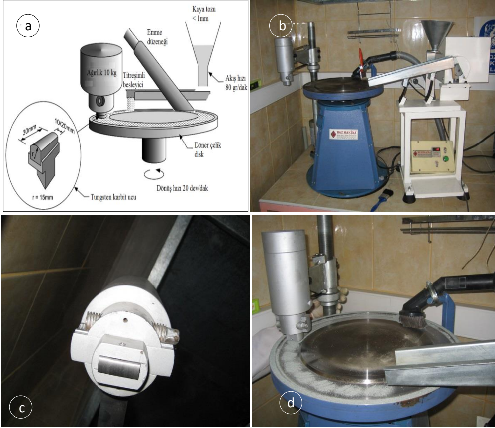
Şekil 2.37. Norveç aşınma deneyi, a) deney düzeneği, b) deney aleti, c) tungsten karbür ucu, d) deneyin yapılışı
