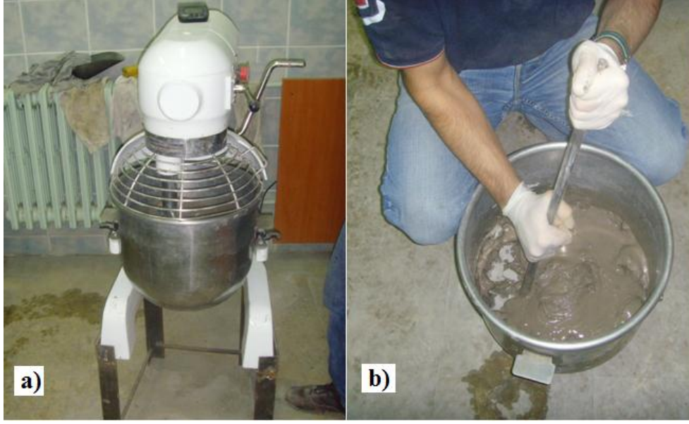
Şekil 2.4. Dolgu karışımında kullanılan mikser (a), karışım malzemelerinin miksere konulmadan yapılan ön karıştırma işlemi (b)
