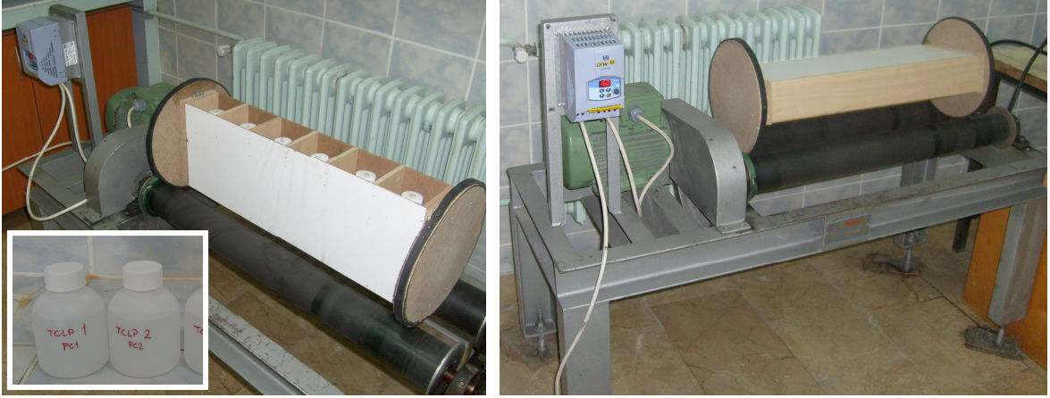
Şekil 34. Çevresel karakterizasyon testlerinde kullanılan deney düzeneği ve polipropilen şişeler (solda küçük resim)
