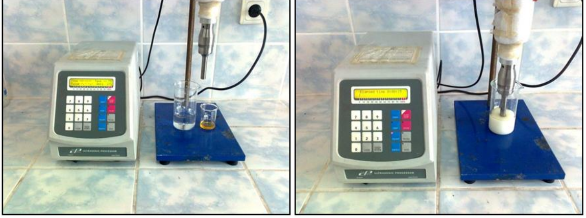
Şekil 3. 45. Atık yağın ses ötesi dalga ile emülsiyeye edilmesi
