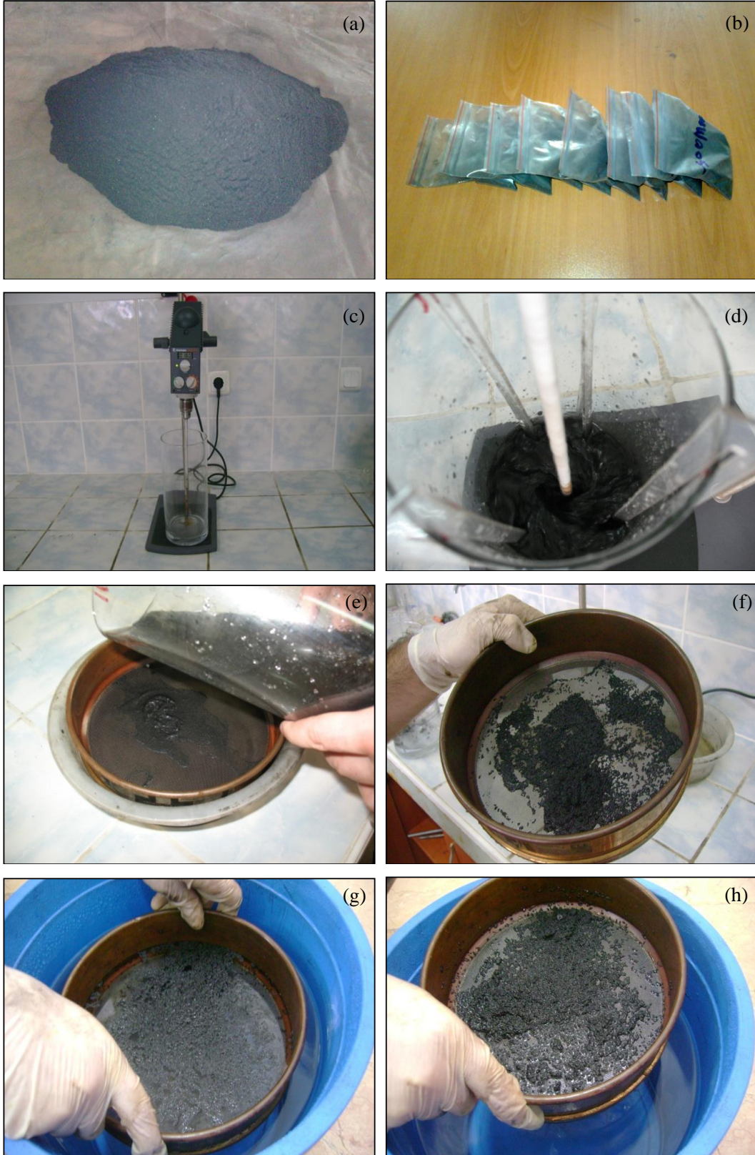
Şekil 2. 9. -0,5 mm'nin altına indirilmiş ve poşetlenmiş kömür örnekleri (a,b), silindirik cam kap ve mekanik karıştırıcı (c), karıştırma işlemi (d), aglomeratların kazanımı (e,f), aglomeratların yıkanması (g,h)
