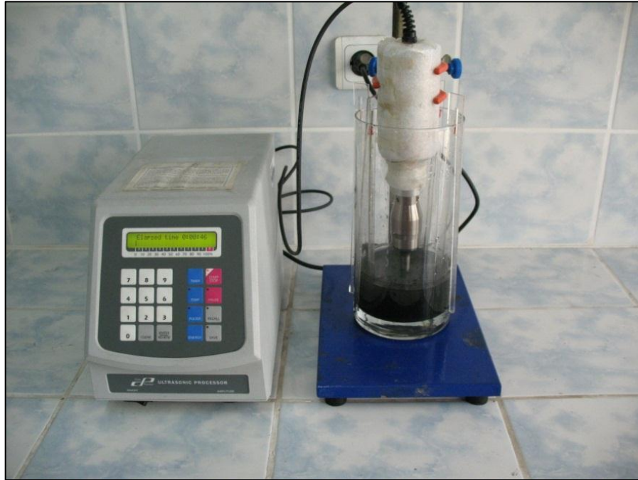
Şekil 3. 39. Kömür-su karışımının ses ötesi dalga işlemine tabi tutulması
