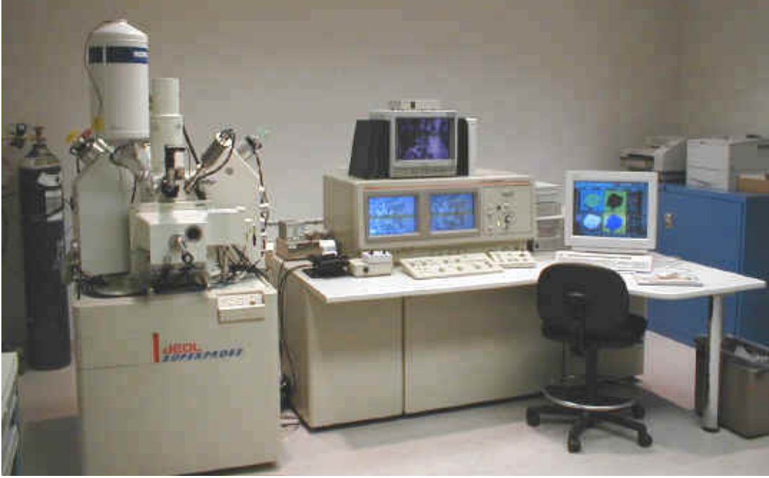
Şekil 2.3. JEOL JXA 8900 marka elektron prob X-ray mikro analizörün görünümü
