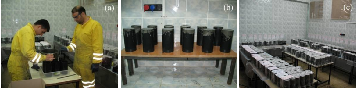
Şekil 2.10. Numunelerin kalıplara yerleştirilmesi (a), bünyedeki fazlalık serbest suyun drene edilmesi (b) ve küre tabi tutulması (c)
