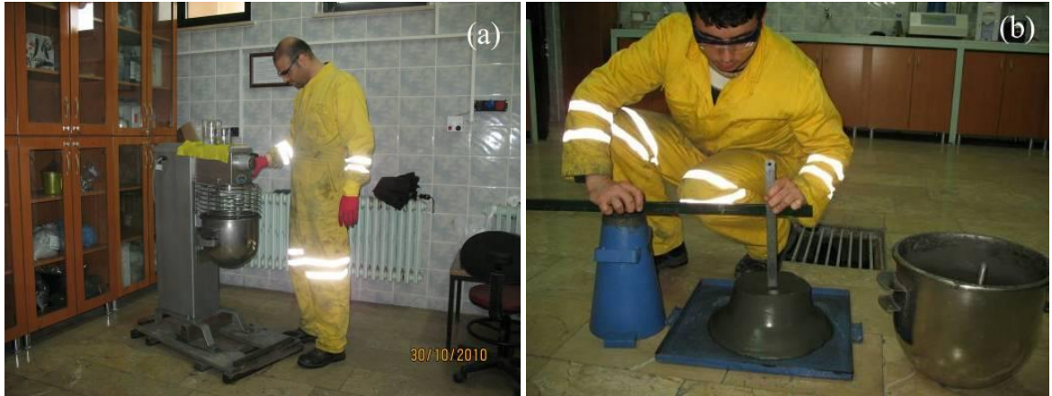
Şekil 2.9. Macun dolgu malzemesinin mikserde karıştırılması (a), kıvamının ölçülmesi (b)
