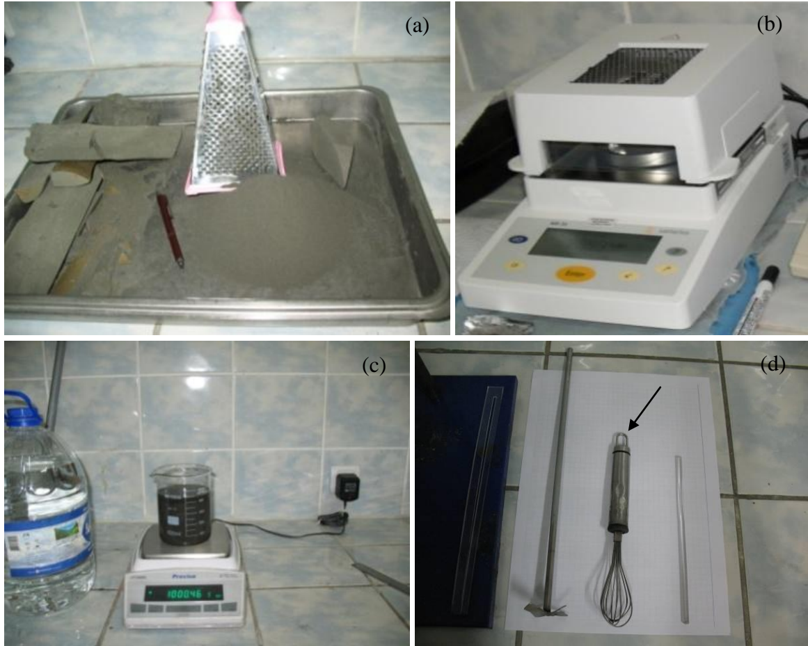
Şekil 2.12. Asit ve sülfat analizleri için numunelerin rendelenmesi (a), nem içeriklerinin tayini (b), katı sıvı oranının %50'ye ayarlanması (c), mikserle karıştırılması (d)
