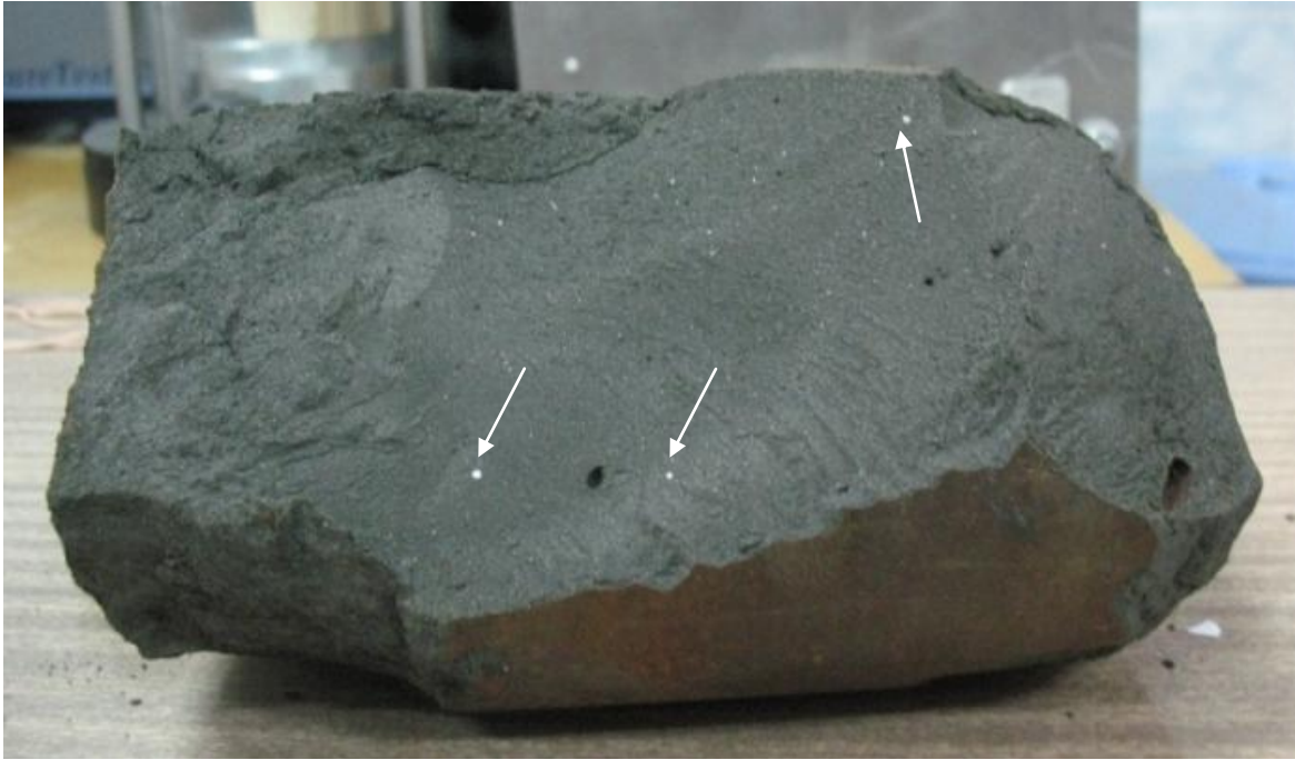
Şekil 1.8. Macun dolgu bünyesinde jips (ikincil alçıtaşı) oluşumu
