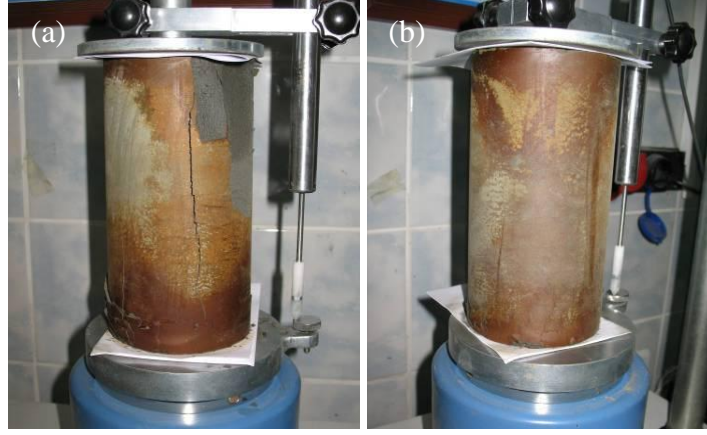
Şekil 3.14. 360 günlük kür süresi sonunda %5 NC-NaOH (a) ve AC-NaOH içeren numuneler (b)
