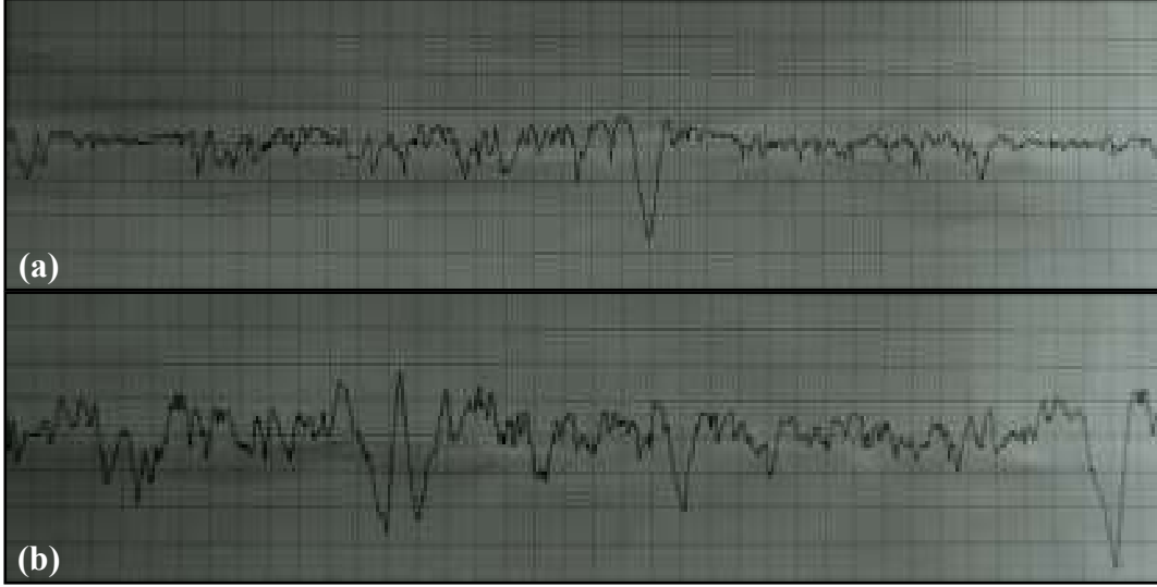
Şekil 3.33. Pürüzlülük ölçümlerinde elde edilen yüzey profilleri a) iri taneli kayaçlardan alınan pürüzlülük ölçümlerinde elde edilen yüzey profili, b) ince taneli kayaçlarda alınan pürüzlülük ölçümlerinde elde edilen yüzey profili
