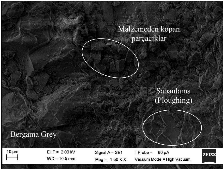
Şekil 3.50. Bergama Grey kesme yüzeyinde SEM görüntüsü (malzemedan kopan parçacıklar, Sabanlama (ploughing) oluşumu)
