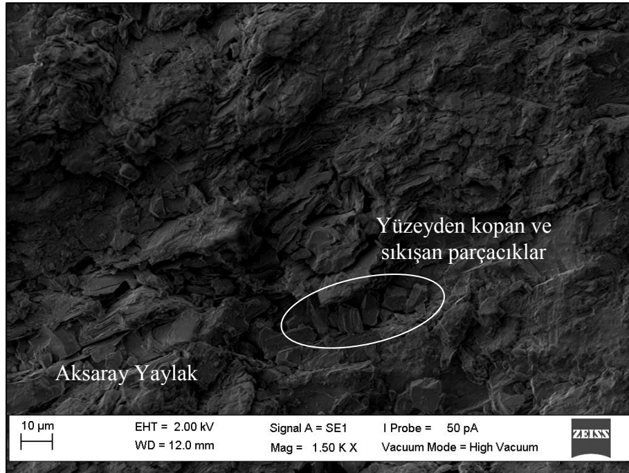
Şekil 3.48. Aksaray Yaylak kesme yüzeyinde SEM görüntüsü (Kopan ve yüzeyde sıkışan parçacıkları)
