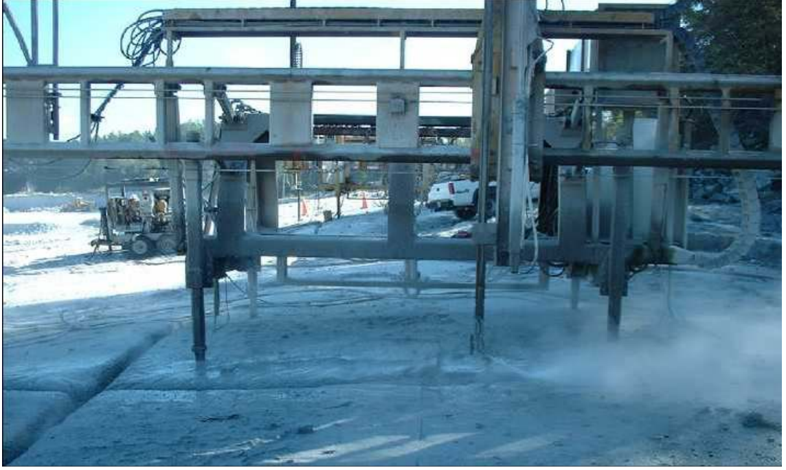
Şekil 1.14. Granit ocağında kullanılan su jeti kesme makinesi (Ferris ve Hall., 2004)
