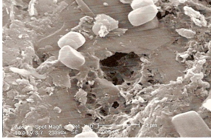
Şekil 14. Mika tanelerinin çimentolu dolgu içerisindeki dağılımı
