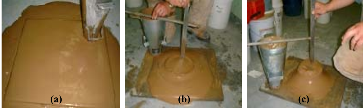
Şekil 7. Slamp değeri yüksek (a), normal (b) ve düşük (c) dolgu
