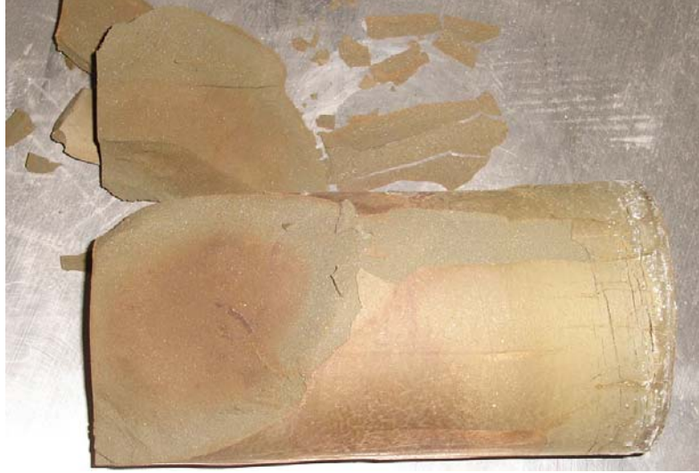
Şekil 69. Çatlaklardan içeriye giren havanın oksidasyona etkisi
