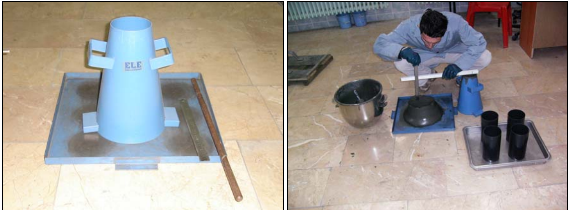
Şekil 47. Slamp test takımı (sol) ve slamp ölçüm işlemi (sağ)
