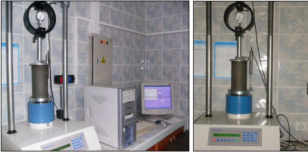
Şekil 50. Bilgisayar kontrollü tek aksenal basınç dayanımı ve deformasyon ölçer cihazı
