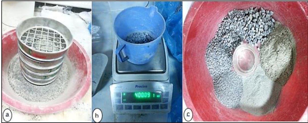
Şekil 11. Laboratuvar ortamında kullanılan (a) elekler, (b) agregaların tartılması ve (c) sınıflandırılmış agrega örnekleri
