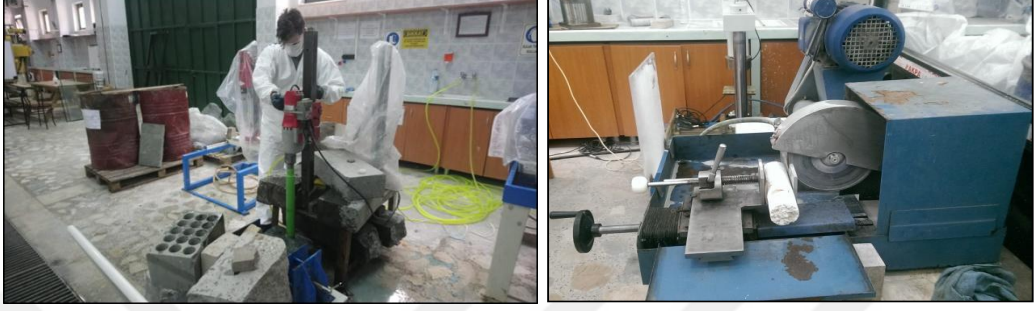
Şekil 2.2. Karot alma işlemi
