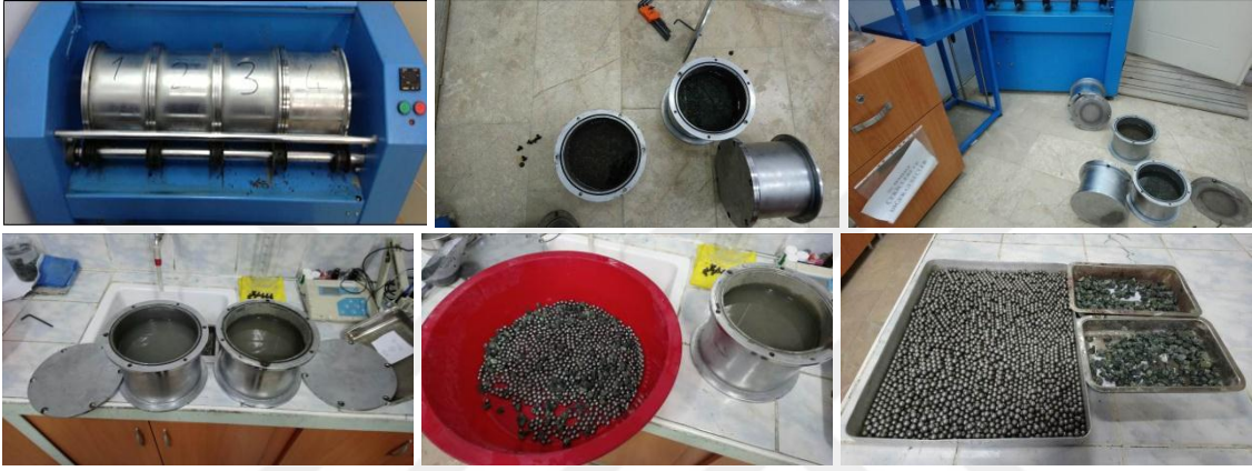
Şekil 2.9. Mikro-Deval aleti ve tamburu
