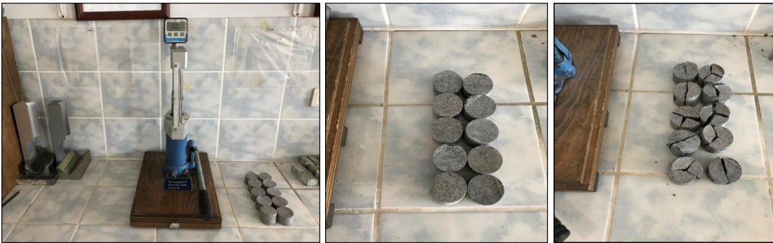
Şekil 2.6. Nokta yük deneyinin gerçekleştirilmesi
