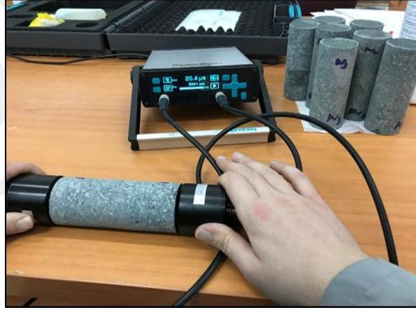
Şekil 2.7. Ultrasonik P-Dalga Hızı Deneyi
