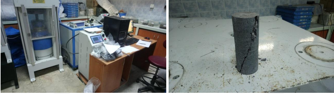
Şekil 2.4. Kayaçların tek eksenli basınç dayanımı deneylerinin gerçekleştirilmesi
