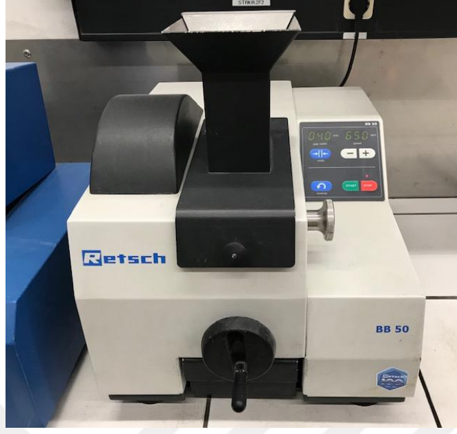
Şekil 2.13. Laboratuvar ölçekli çeneli kırıcı
