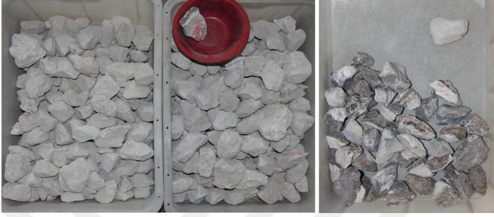
Şekil 1.7. Renk ayırıcı sensörle fosfattan, daha koyu renge sahip silisli şistin ayrılması (Tomra, 2020)
