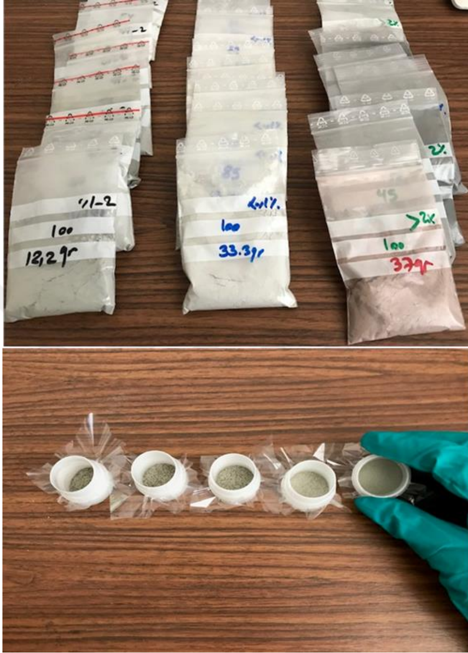
Şekil 2.16. XRF analizi için farklı kalay içeriklerine sahip toz numuneler ve deney kapları
