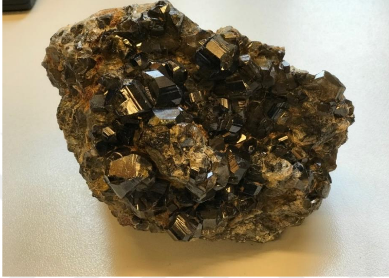
Şekil 2.2. Bolivya Viloco madeninden alınan saf Kasiterit numunesi
