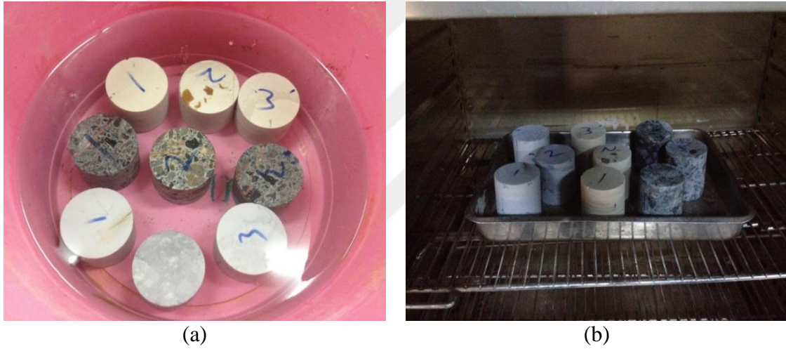
Şekil 2.11. Kuru ve doymun yoğunlukların hesaplanmasından önce deney numunelerinin a) suya doymun b) kurutma işlemi
