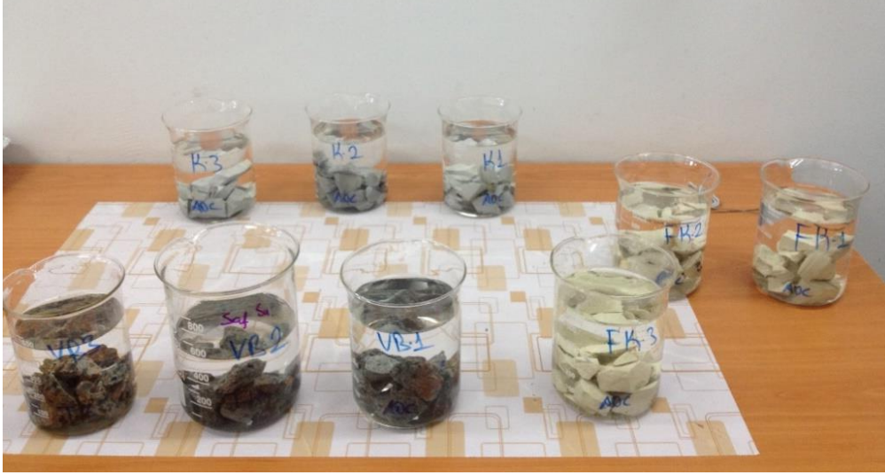
Şekil 2.7. Arşimet deneyi için doygun hale getirilen numuneler
