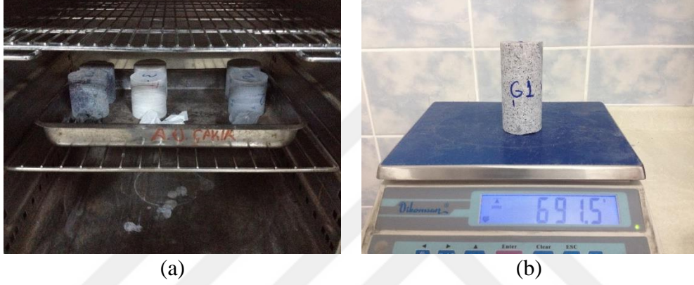
Şekil 2.8. a) Karot numunelerini kurutma işlemi b) 0.01 hassasiyette ağırlık ölçümü
