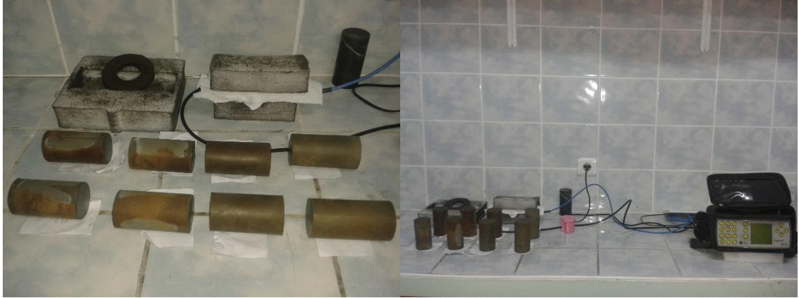
Şekil 13. Macun dolgu numunelerinin ultrasonik P-dalga hızı ölçümlerinin yapılması
