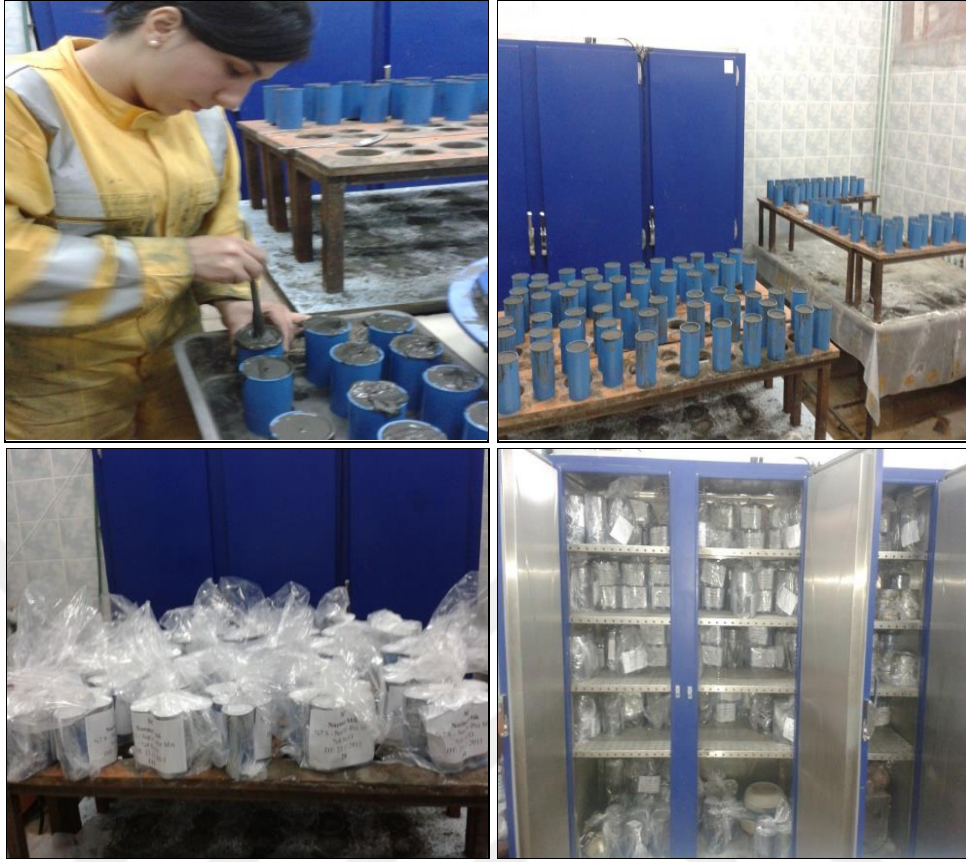
Şekil 9. Numunelerin sıkılanması (a), bünye serbest suyunun drene edilmesi (b), numunelerin hava ile temasının kesilmesi (c), kür dolabında bekletilmesi (d)
