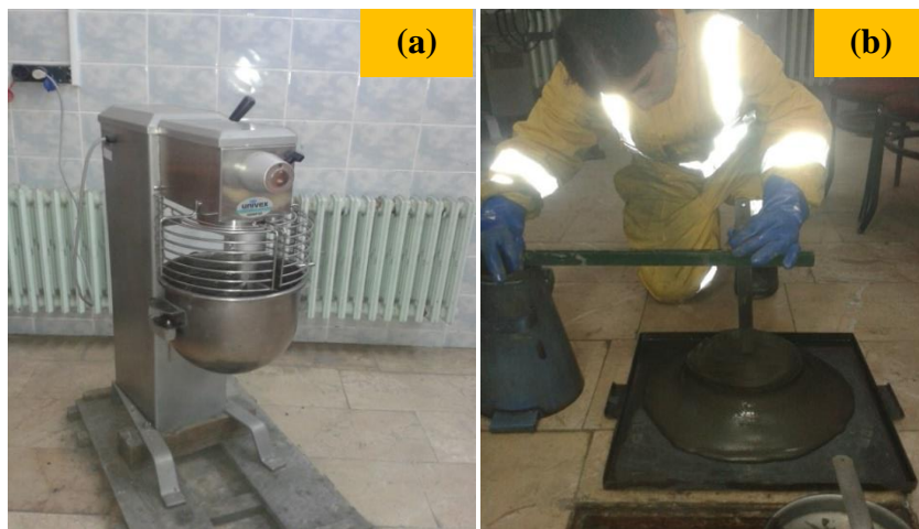
Şekil 8. Malzemelerin mikserde karıştırılması (a) ve uygun kıvamda hazırlanması (b)
