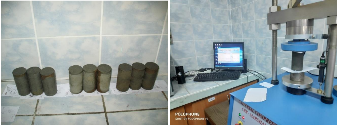
Şekil 10. Tek eksenli basınç dayanımı testlerinin gerçekleştirilmesi
