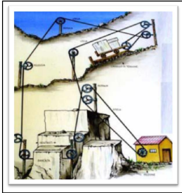
Şekil 1. Helezon telle mermer kesme (Eleren ve Ersoy 2007).
