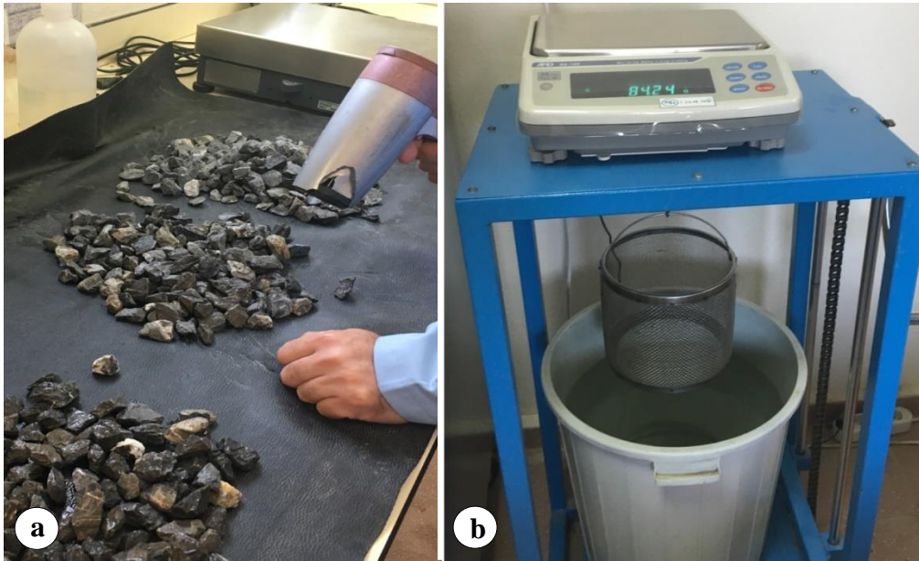
Şekil 2.18. a) DKY haline getirilen iri agregalar, b) özgül ağırlık deney düzeneği
