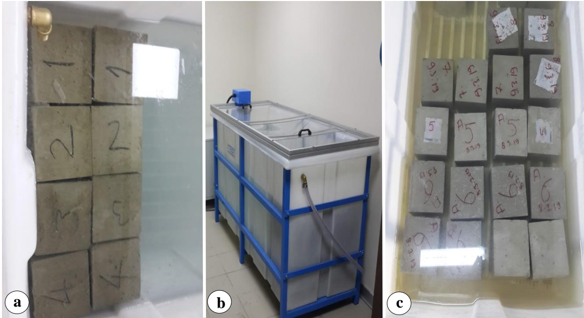
Şekil 2.34. Kür; a) kürdeki numuneler b) kür tankı c) kür işlemindeki numuneler
