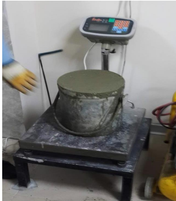
Şekil 2.31. Taze beton yoğunluk deneyi
