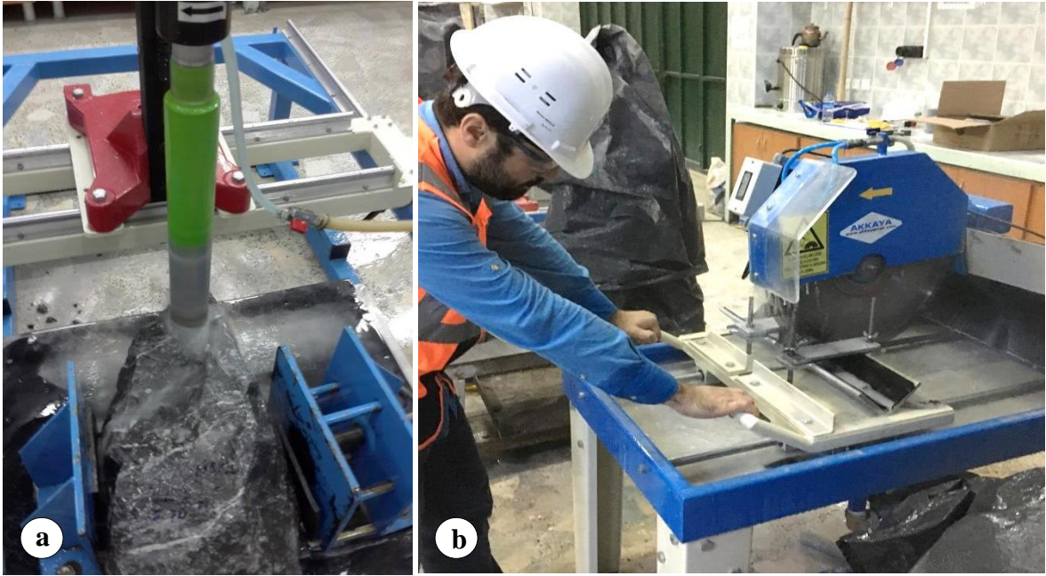
Şekil 2.6. Numune alımı; a) karot alma işlemi b) karot kesme ve düzeltme makinesi
