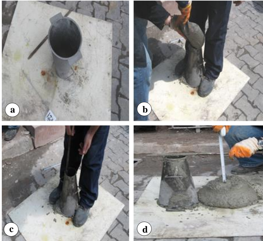
Şekil 2.30. Çökme deneyi; a) huni, b) dolum, c) şişleme, d) ölçüm
