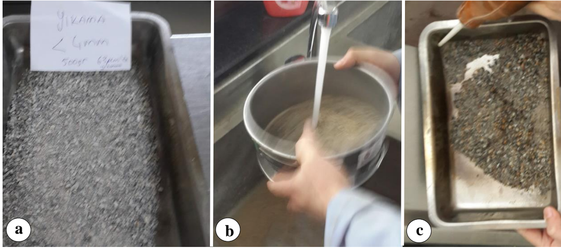
Şekil 2.24. Yıkama yöntemi ile ince madde miktarının belirlenmesi; a) etüv kurusu numune, b) yıkama, c) yıkanan numune
