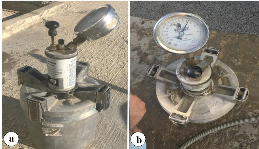
Şekil 2.32. Taze beton hava ölçme deneyi; a) deney cihazı, b) ölçüm sayacı
