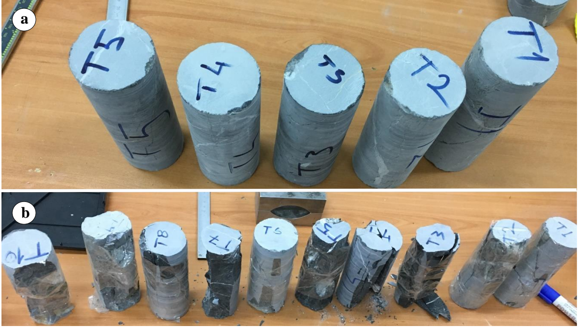
Şekil 2.9. Numunelerin durumları; a) deney öncesi numuneler b) deney sonrası numuneler
