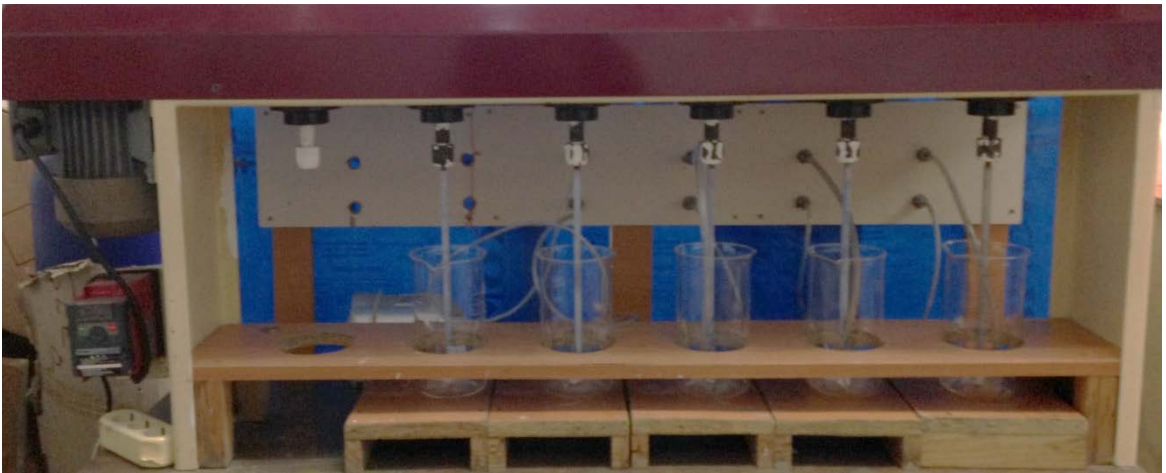
Şekil 30. Çoklu mekanik karıştırılmalı liç düzeneği
