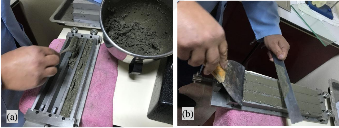
Şekil 2.8. Kalıpların doldurulması (a-b)
