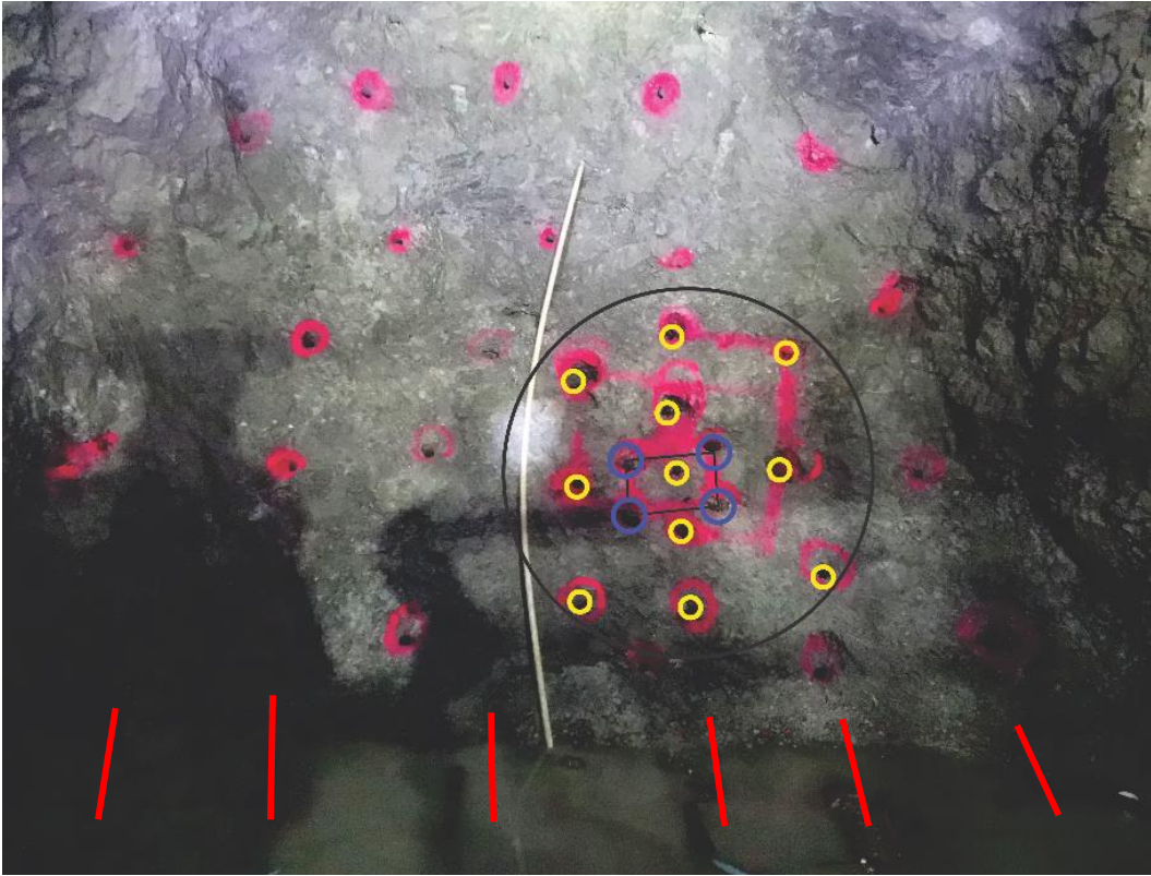
Şekil 13. Z3D30 nolu galeri aynasında uygulanan patlatma dizaynı örneği (22/12/2018)
