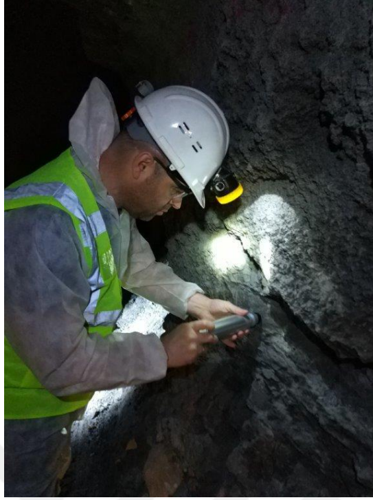
Şekil 8. Schmidt çekici testinin yeraltı aynalarında uygulanması
