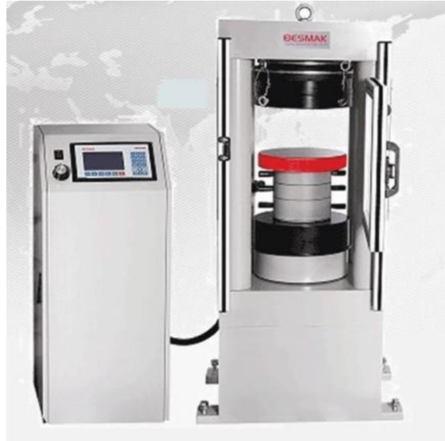
Şekil 2.7. Tek eksenli basınç dayanımının belirlenmesinde kullanılan cihaz
