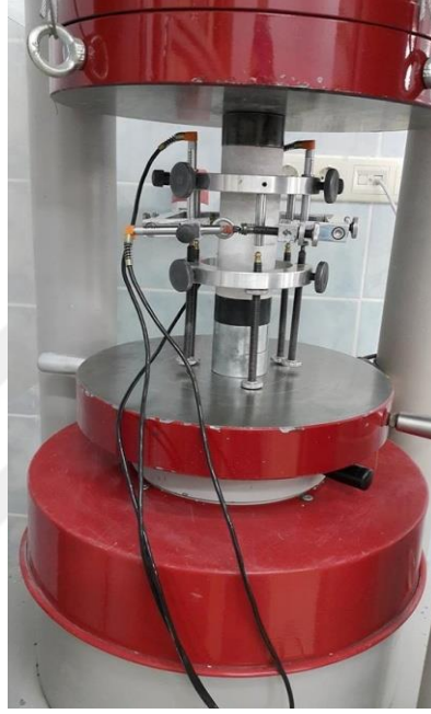
Şekil 2.12. Tekrarlı yükleme düzeneği
