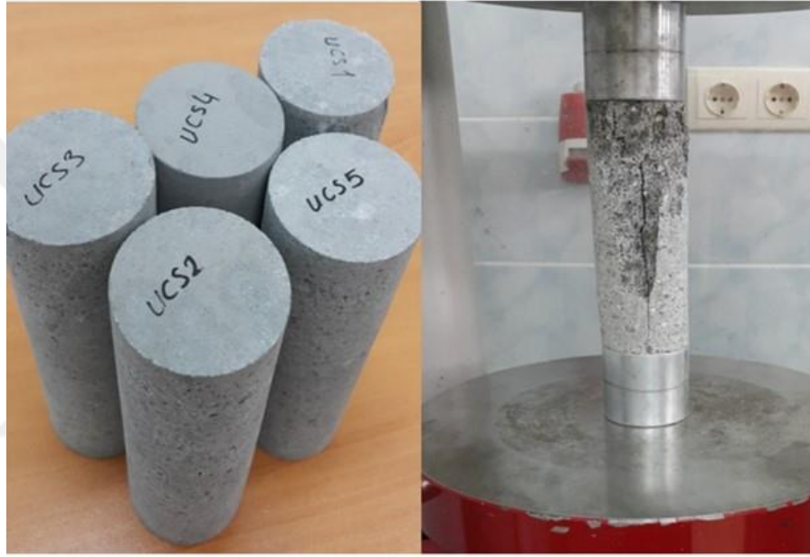
Şekil 2.8. Örnek numuneler ve deney sonrası kırılan numune
