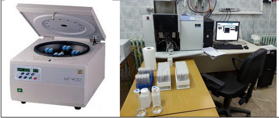
Şekil 12. (a) Nüve NF 400 santrifuj cihazı; (b) Perkin Elmer AAnalyst 400 atomik absorpsiyon spektrometresi
