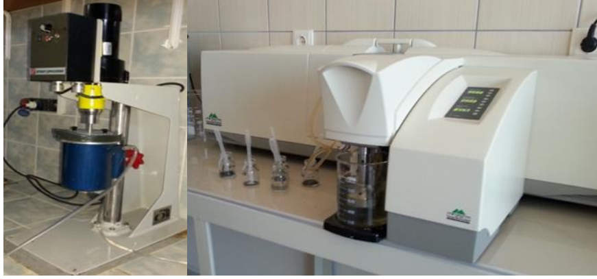
Şekil 8. (a) Öğütme işleminde kullanılan karıştırma değirmeni, (b) Tane boyut dağılımı için kullanılan Malvern Mastersizer Hydro 2000 MU cihazı
