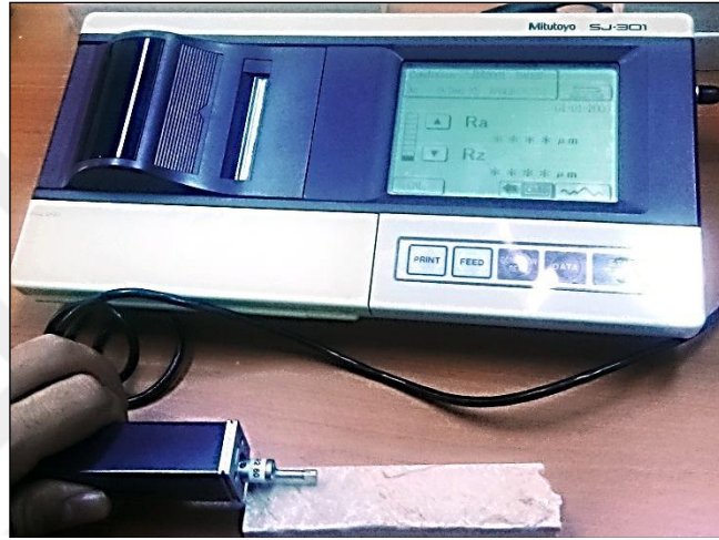
Şekil 2.15. Pürüzlülük ölçüm cihazı ve kesim yüzeylerinde pürüzlülük değerlerinin ölçümü
