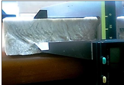
Şekil 2.14. Kesme derinliğinin ölçümü
