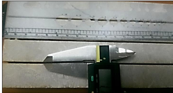
Şekil 2.10. Kesme genişliğinin ölçümü
