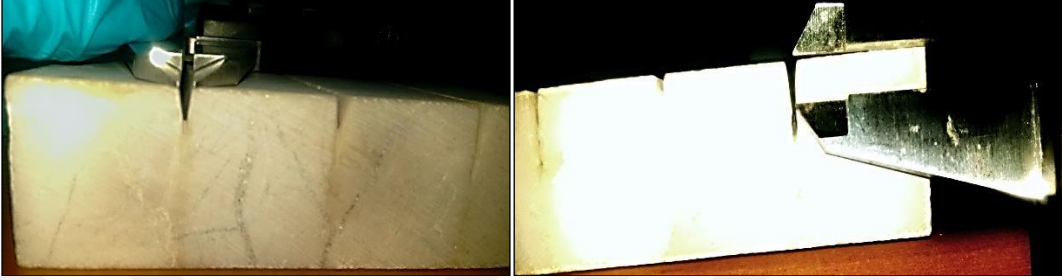
Şekil 2.11. Kerf açısı hesaplamak için kullanılacak parametrelerin ölçümü
