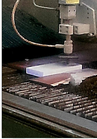
Şekil 2.6. ASJ ile mermer kesim işlemi
