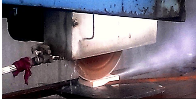
Şekil 2.12. Mermer plakaların dairesel testere ile kesimi
