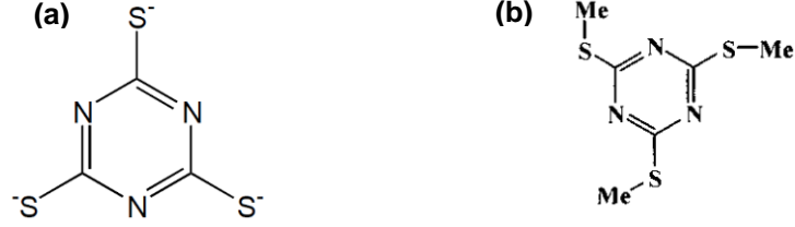
Şekil 13. TMT (a) ve metal-TMT (b) bileşiğinin yapısı (Yazıcı vd., 2011)
