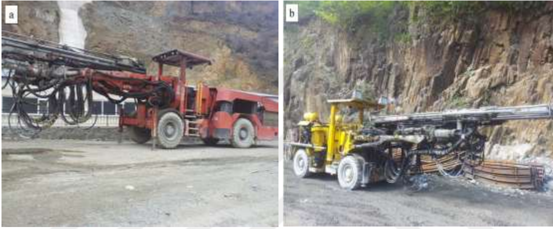
Şekil 2.4. Tünellerde delme işlem için kullanılan makinalar a) Sandvik DT820 ve b) Atlas Copco Rocket Boomer 282
