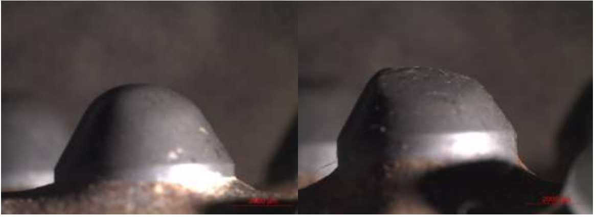
Şekil 3.20. Yarı balistik butonlu bitlerde buton alt çapının aşınımı
