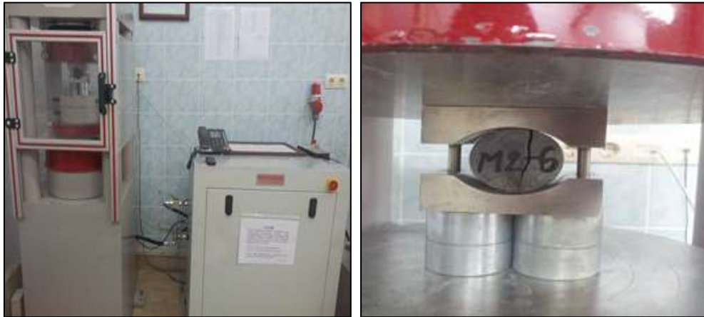
Şekil 2.13. Numune yerleştirilmesi ve kırılan numune
