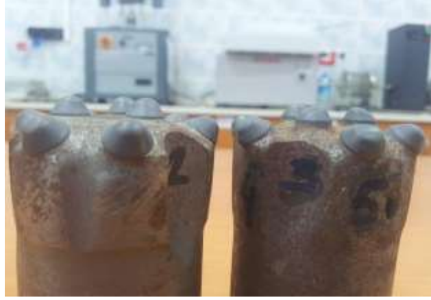
Şekil 3.19. Yarı balistik butonlu bitlerde buton ve gövde aşınımı
