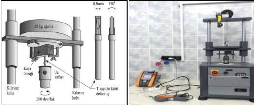
Şekil 2.21. Sievers minyatür delme düzeneği ve delme deneyi aleti
