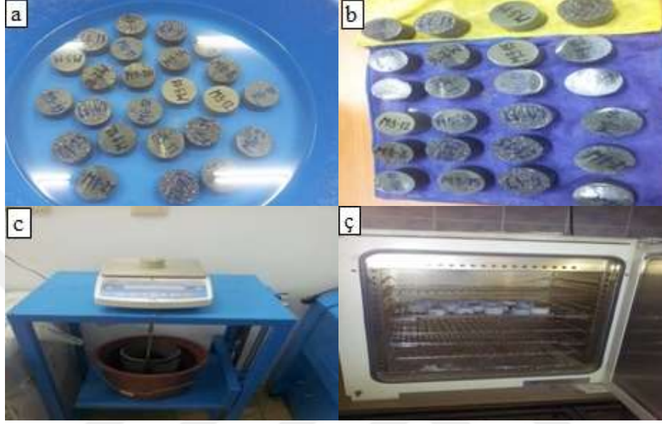
Şekil 2.11. Kayaçların fiziksel özelliklerini belirlemek için gerçekleştirilen aşamalar, a) suya doyurma b) doygun haldeki numuneler, c) Arşimet terazisiyle numune tartımı, ç) fırında kurutma
