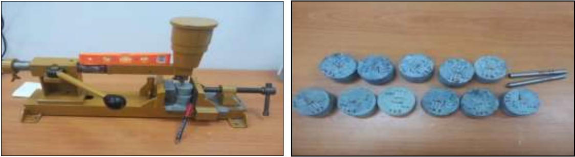
Şekil 2.17. Cerchar aşındırıcılık aleti ve deneyde kullanılan kayaç örnekleri
