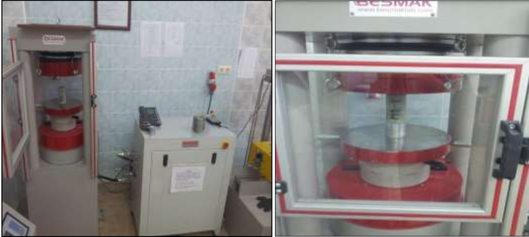
Şekil 2.12. Tek eksenli basınç dayanımı deneyinin yapılışı
