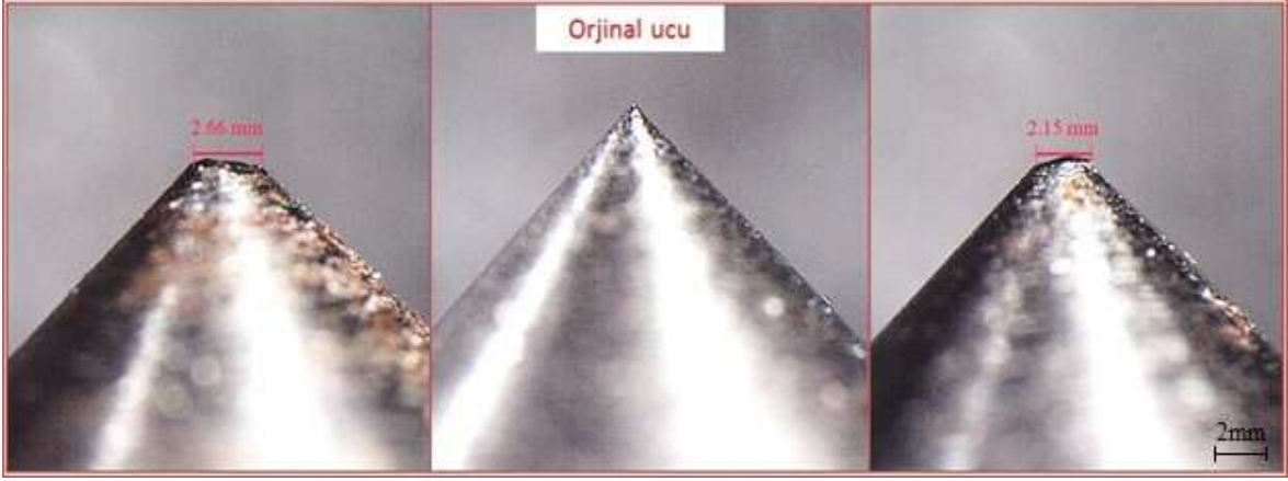
Şekil 2.19. Aşınma sonrası uçların mikroskop altında bir görünüşü
