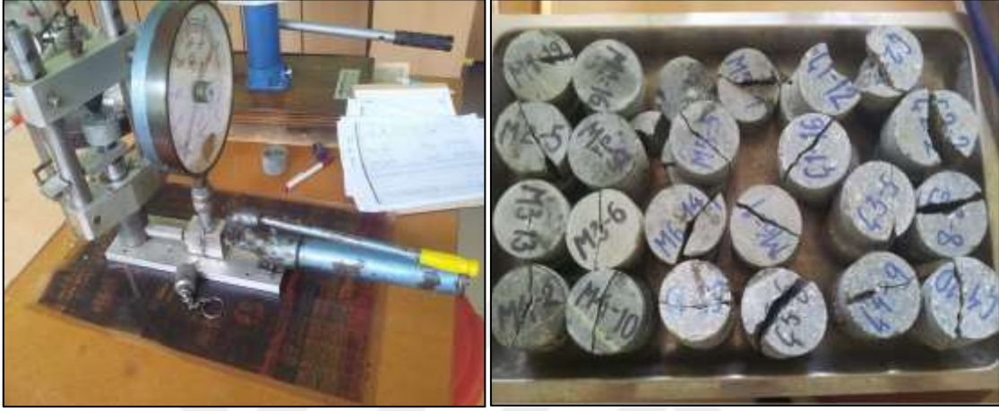
Şekil 2.14. Nokta yükleme deneyi aleti ve deney sonrası kırılmış kayaç örnekleri
