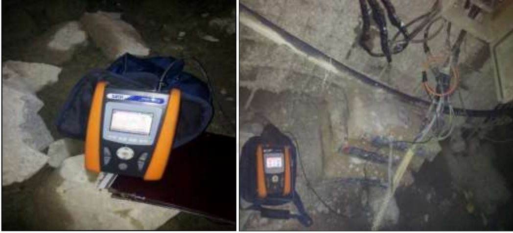
Şekil 2.5. Jumbo makinalarının spesifik enerji değerlerini hesaplamak için akım ölçümleri alımı
