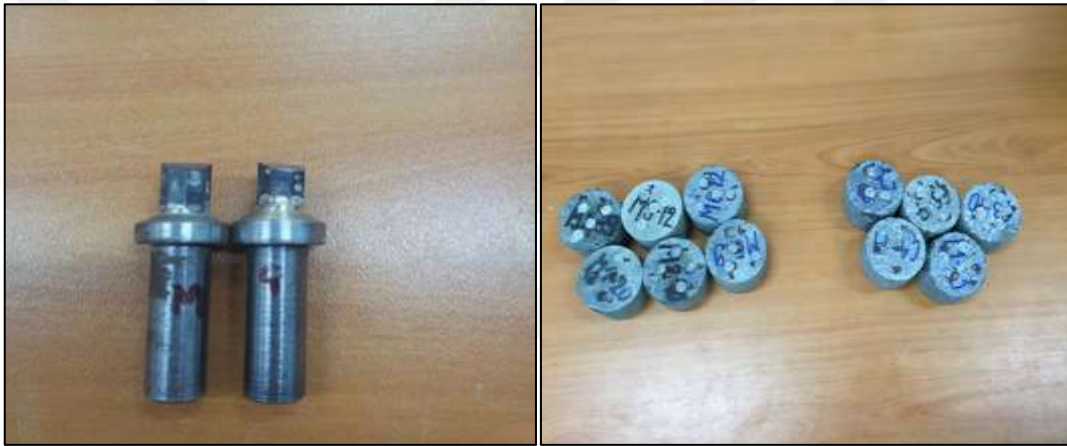
Şekil 2.22. SJ deneylerinde kullanılan uçlar ve deneyde kullanılan kayaç örnekleri
