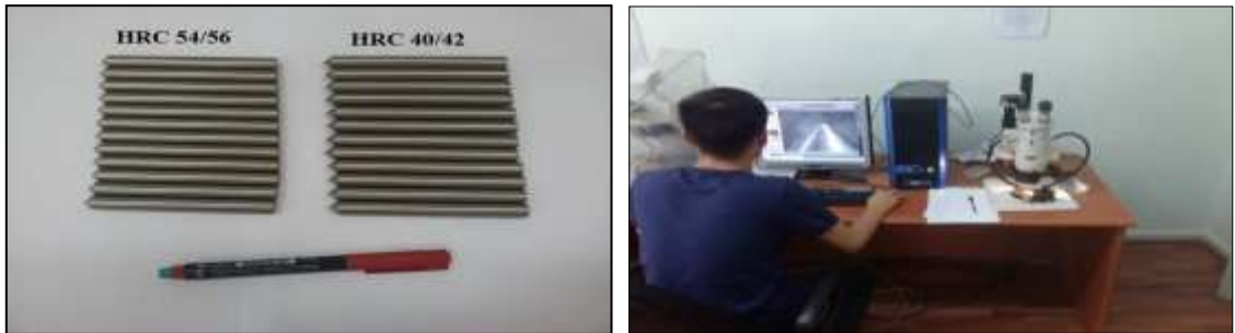
Şekil 2.18. Cerchar aşındırıcılık deneyinde kullanılan uçlar ve mikroskop altında okunması
