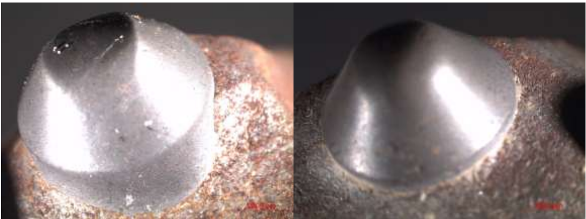
Şekil 3.21. Yarı balistik butonlu bitlerde buton ucu aşınımı
