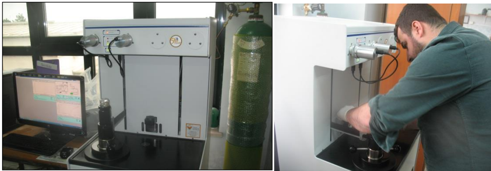
Şekil 7. Macun dolgu malzemelerinin ilgili kür süresinde civalı porozimetre cihazı ile gözeneklilik analizlerinin yapılması
