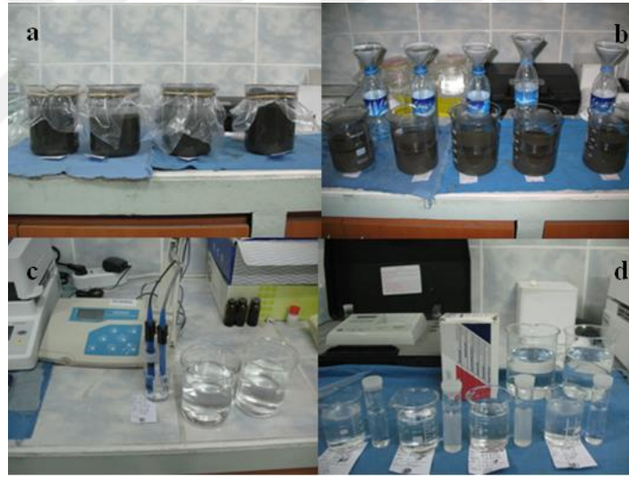
Şekil 5. Numunelerin mikserle karıştırıldıktan sonra bekletilmesi (a), süzülmesi (b), pH (c) ve sülfat içeriği tayinlerinin yapılması (d)
