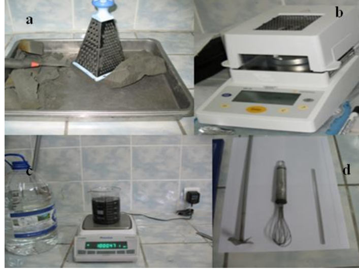
Şekil 4. Asit ve sülfat analizleri için numunelerin rendelenmesi (a), nem içeriklerinin tayini (b), katı sıvı oranının %50'ye ayarlanması (c), mikserle karıştırılması (d)
