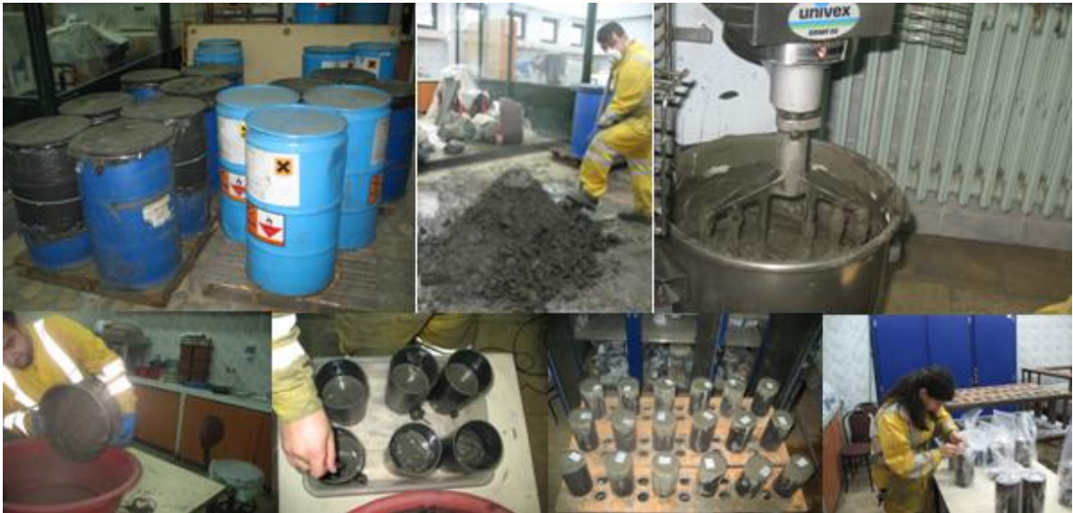
Şekil 2. Macun dolgu numunelerinin kür dolabında kür işlemine tabi tutulması
