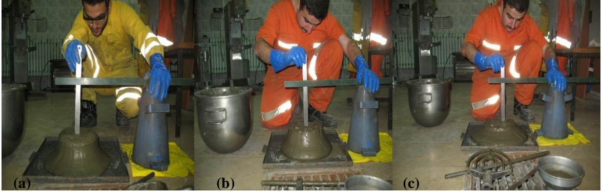
Şekil 3. Slamp değeri düşük (a), normal (b) ve yüksek (c) dolgu
