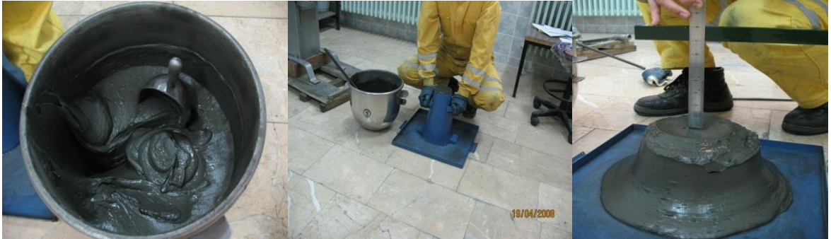
Şekil 6. Macun dolgu kıvamının slump testi ile ölçülmesi
