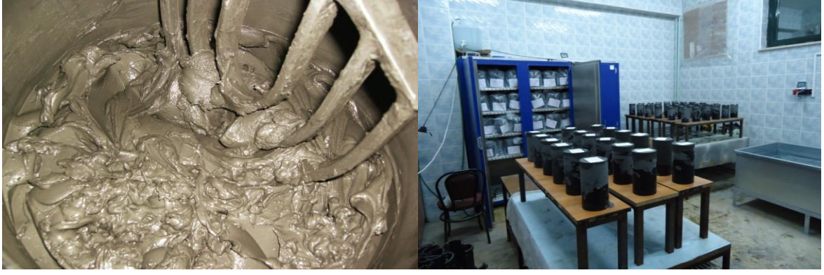
Şekil 9. Macun dolgu numunelerinin kür dolabında kür işlemine tabi tutulması
