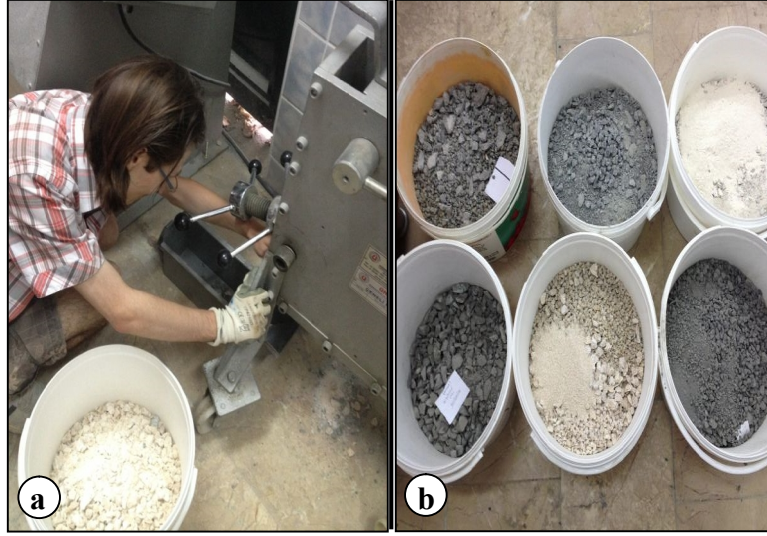
Şekil 2.5. Kırma taş numunelerinin hazırlanması. a) Çeneli kırıcı ile kırma işlemi, b) Kırma taş numuneleri
