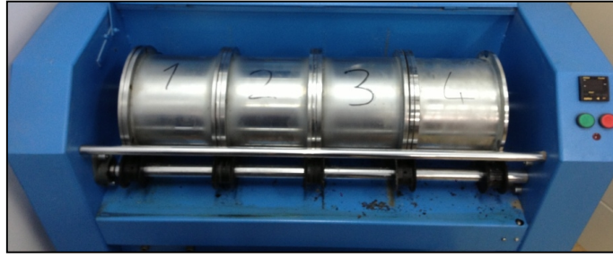
Şekil 1.11. Micro-Deval aşındırma cihazı
