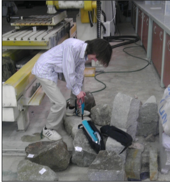
Şekil 2.9. Schmidt çekici ile ölçüm alımı
