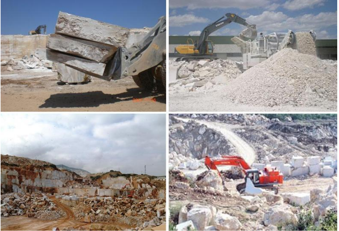
Şekil 5. Ocaklardan açığa çıkan mermer atıkları
