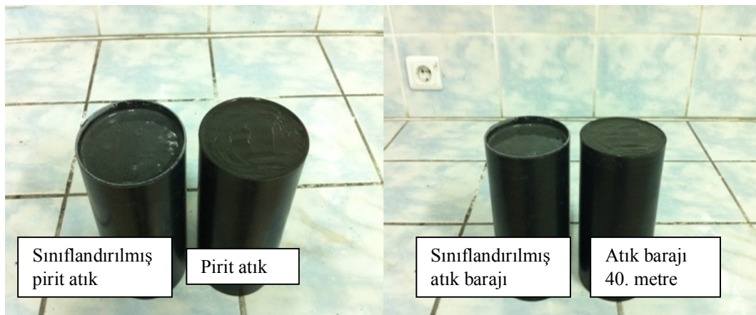
Şekil 15. Sınıflandırılmış pirit ve baraj atıklarının çökme karakteristikleri
