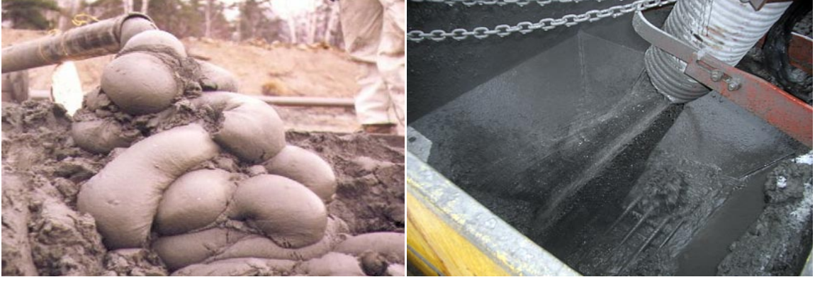
Şekil 9. Macun dolgunun akışkan görünümü ve boru hattıyla yeraltına iletilmesi
