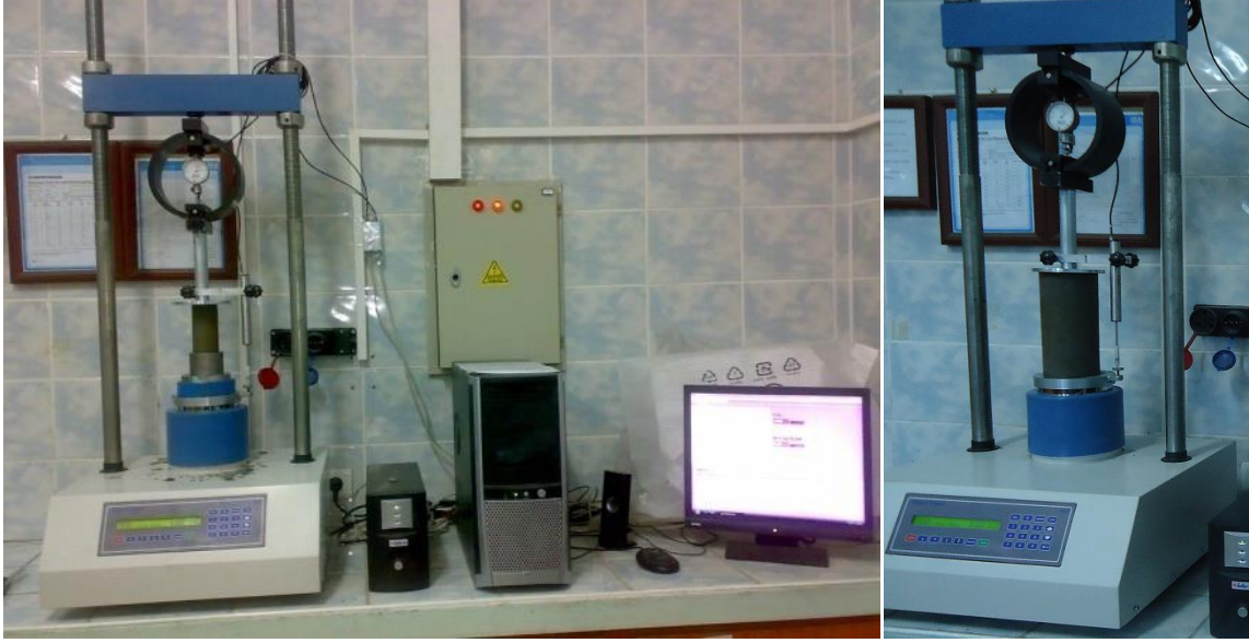
Şekil 17. Bilgisayar kontrollü tek eksenli basınç dayanımı test cihazı ve iki farklı boyuttaki örneklerin görünümü
