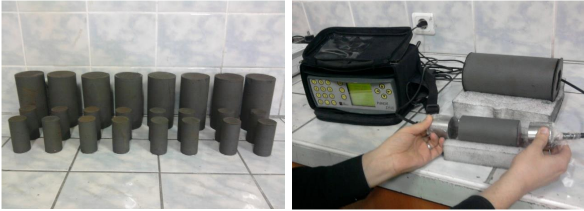
Şekil 16. Ultrasonik P- dalga hızı testi öncesi macun dolgu örnekleri (a), ultrasonik P- dalga hızı test işlemi (b)
