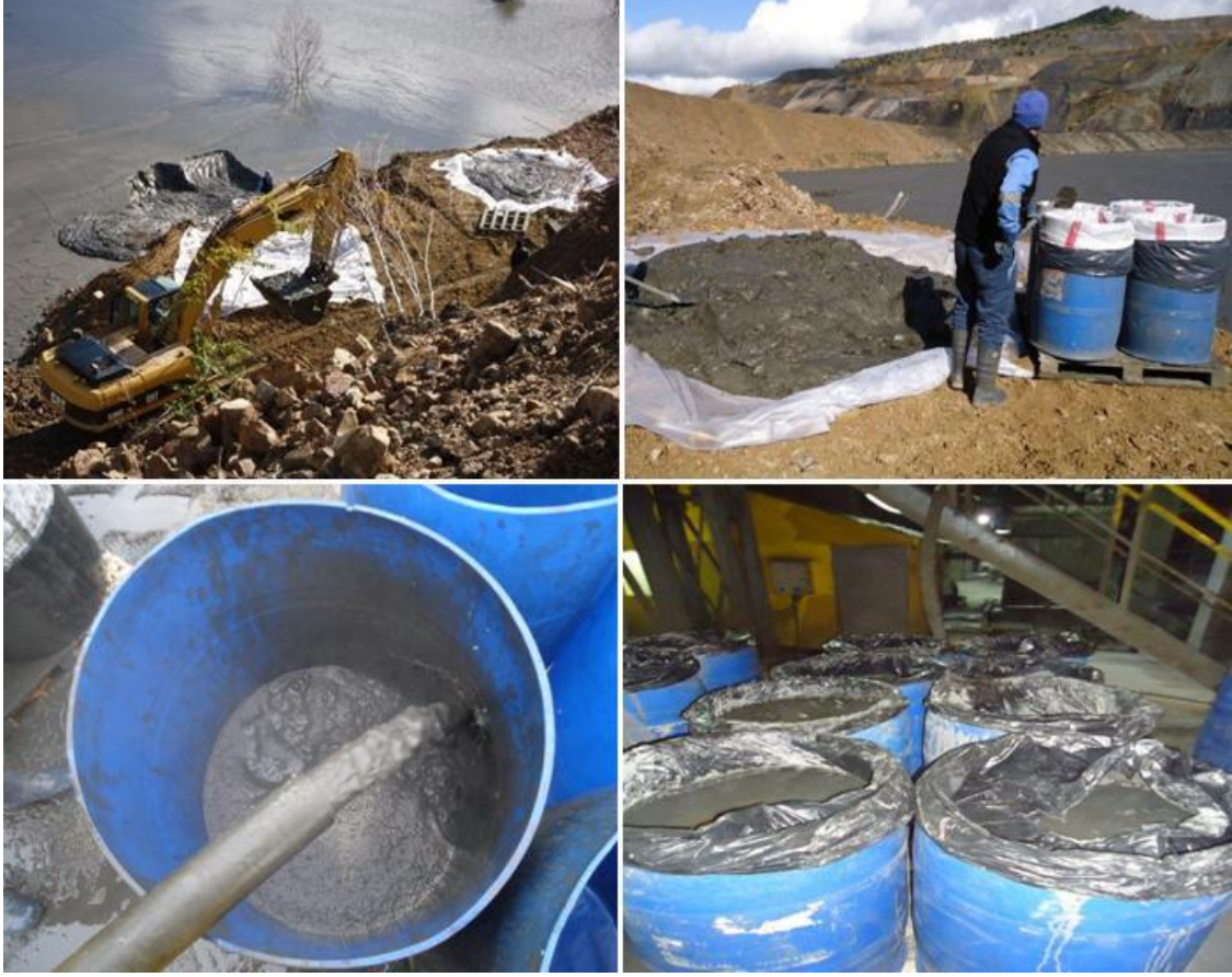
Şekil 12. Atık malzemelerin cevher hazırlama tesis çıkışından ve atık barajından alınması ve varillere doldurulması
