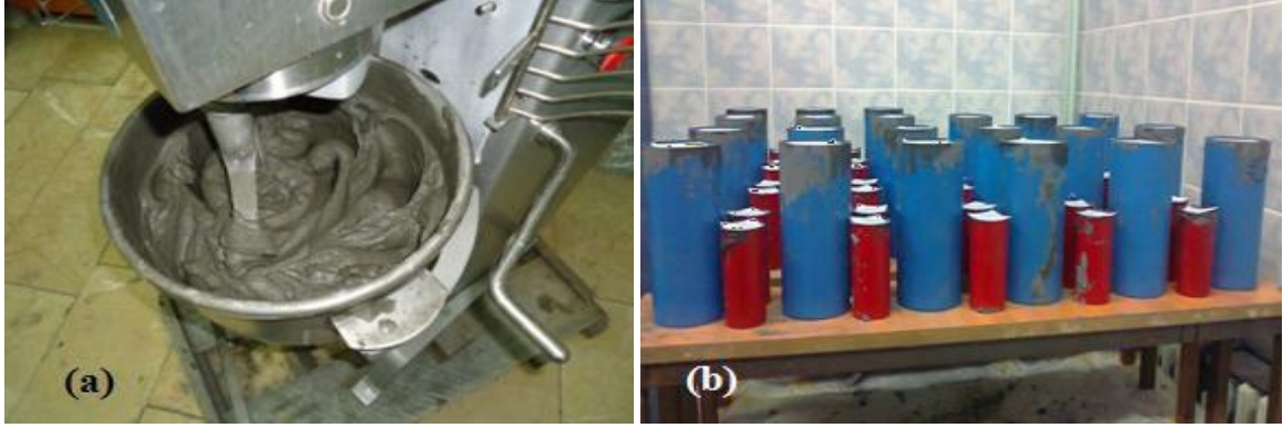
Şekil 15. Macun dolgu karışımında kullanılan mikser (a) ve macun dolgu örneklerinin drenaj işlemi (b)
