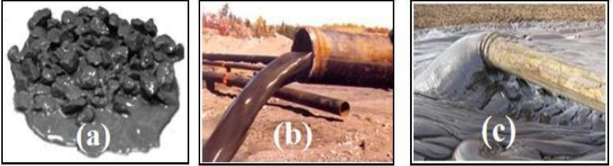
Şekil 1. Madencilikte kullanılan kaya (a), hidrolik (b) ve macun (c) dolgunun görünümü (Erçikdi, 2009)
