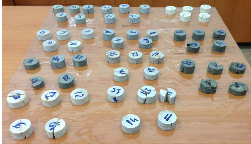
Şekil 2.10. Nokta-yük dayanımı deneyinde kırılan numuneler
