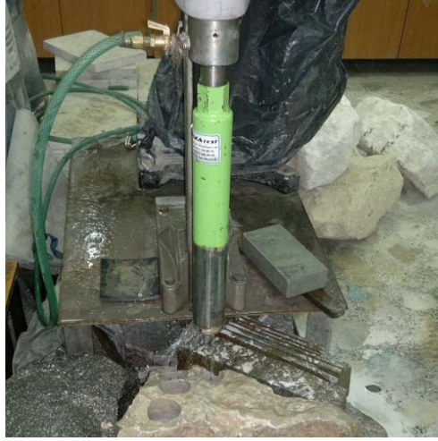
Şekil 2.3. Karot alma işlemi
