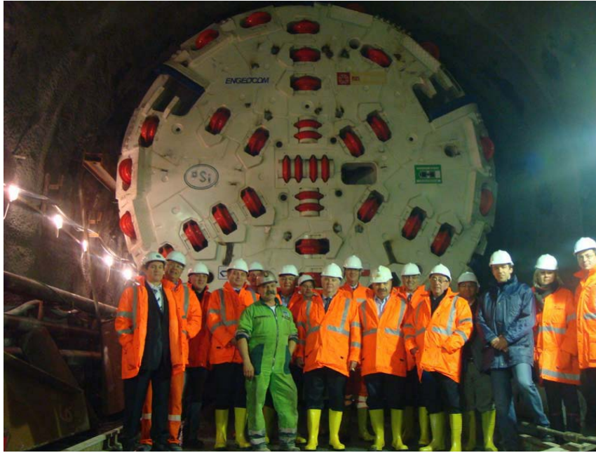
Şekil 1.7. Melen Boğaziçi Tüneli'nde çalışan tünel açma makinesi (TAM)
