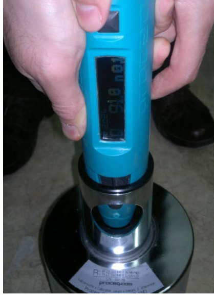
Şekil 2.12. Schmidt çekicinin kalibre edilmesi
